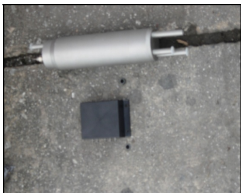
Εικόνα 23. Εξάρτημα προσάρτησης κινητήρα diesel για χρήση κραμβέλαιου
