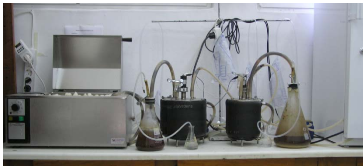
Εικόνα 7.2: Πειραματική διάταξη των αναερόβιων αντιδραστήρων συνεχούς λειτουργίας που χρησιμοποιήθηκαν στην ερευνητική εργασία.
