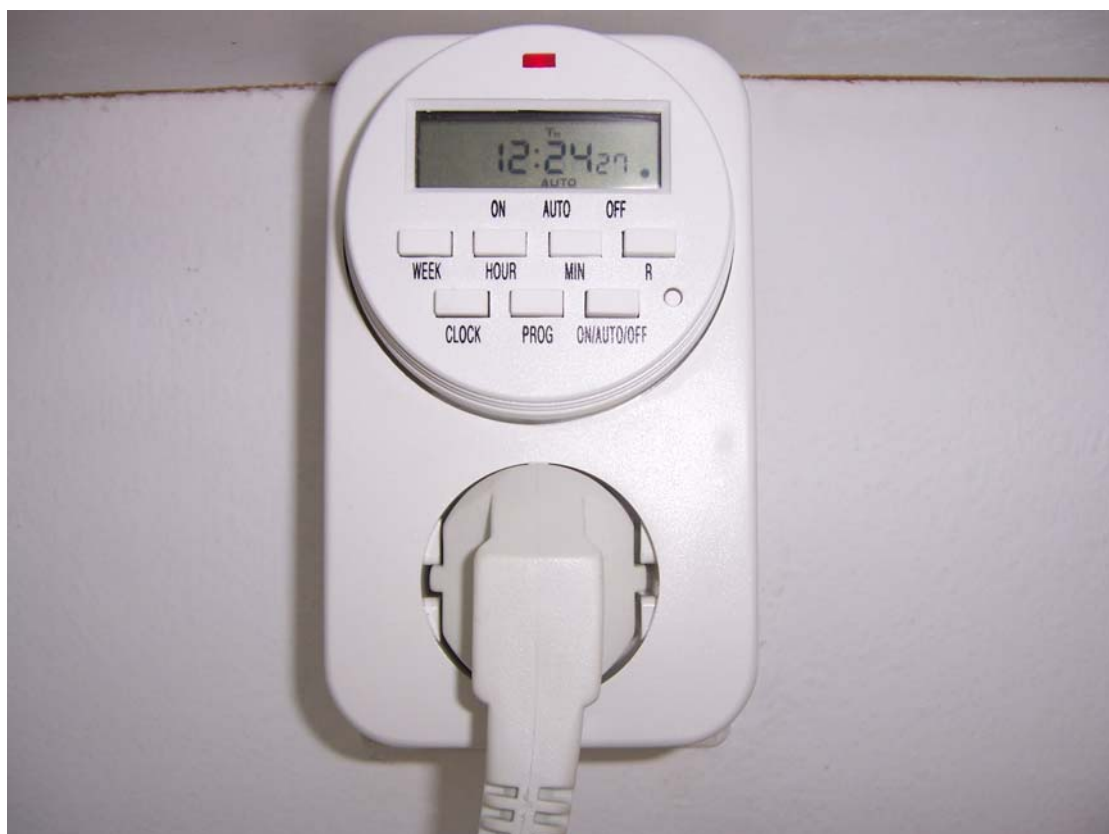
Εικόνα 15: Ψηφιακός χρονοδιακόπτης για τον έλεγχο των επιμέρους τμημάτων του αντιδραστήρα.
