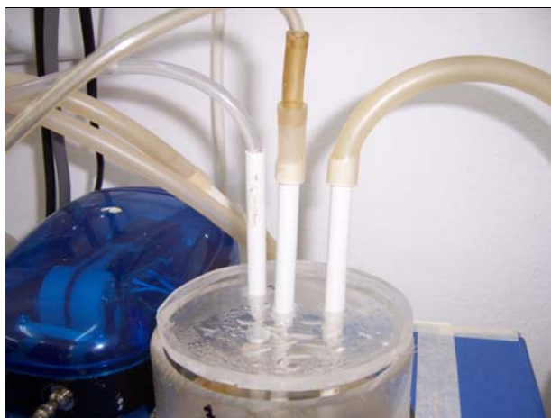
Εικόνα 7 : Συνδεσμολογία τροφοδοσίας, δειγματοληψίας, απορροής στο επάνω τμήμα του αντιδραστήρα.
