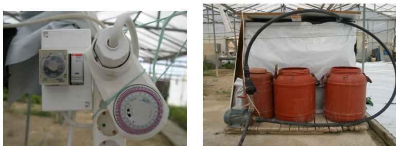
Εικόνα 4.7 Αριστερά: Χρονοδιακόπτης. Δεξιά: Αντλία και δοχεία με θρεπτικά διαλύματα A & B.
