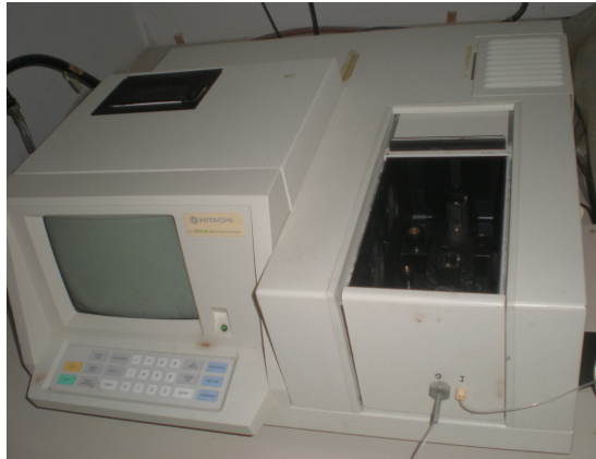
Εικόνα 6.2 Φασματοφωτόμετρο πολλαπλής ανάγνωσης για την στοιχειομετρική ανάλυση της χλωροφύλλης \alpha -, \beta - και ολικών καροτενοειδών.
