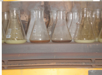
Εικόνα 4.19 Η ειδική πλάκα θέρμανσης και οι αλλαγές στο χρώμα κατά την διάρκεια παραμονής των δειγμάτων.
