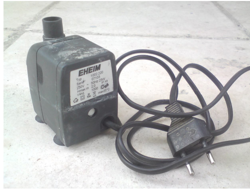
Εικόνα 4.4 Αντλία μεταφοράς του θρεπτικού διαλύματος στην καλλιέργεια.
