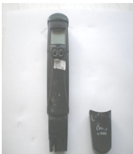
Εικόνα 4.14 Φορητό πεχάμετρο-αγωγιμόμετρο για τη μέτρηση pH και E.C.
