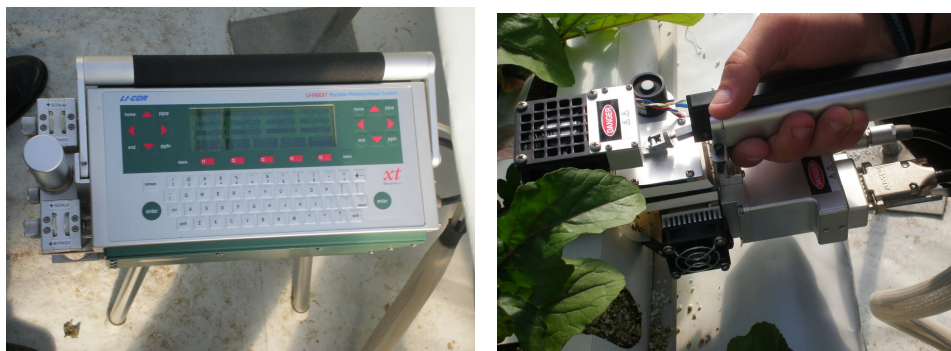
Εικόνα 4.24 Φορητή συσκευή υπέρυθρης ανάλυσης αερίων (model LI-6200, Li-Cor, Inc., Lincoln, NE).
