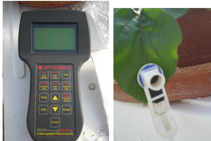
Εικόνα 4.23 Το όργανο μέτρησης φθορισμού opti-sciences και τα ειδικά μανταλάκια φθορισμού.
