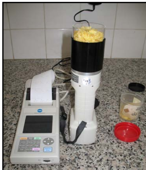
Εικόνα 5: Χρωματόμετρο Minolta® CR 410 για λήψη των παραμέτρων L^* και a^* .
