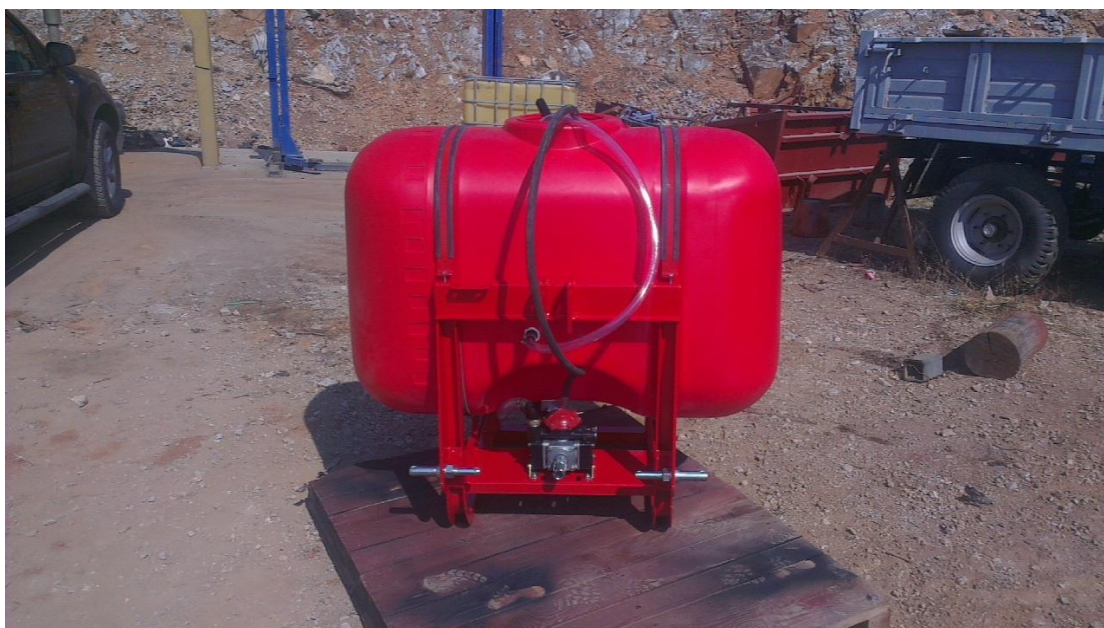
Εικόνα 31: Υδραυλικός ψεκαστήρας ζιζανιοκτονίας χωρητικότητας 500 λίτρων
