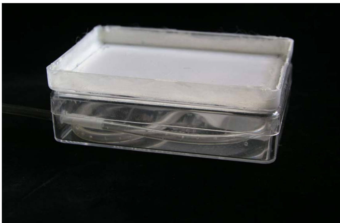
Εικόνα 10. Συσκευή νάρκωσης. Στο εσωτερικό παρατηρείται ο διάτρητος σωλήνας πολυαιθυλενίου παροχής CO 2 .
