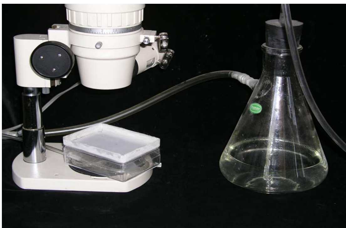
Εικόνα 11. Σύστημα νάρκωσης αλευρωδών.
