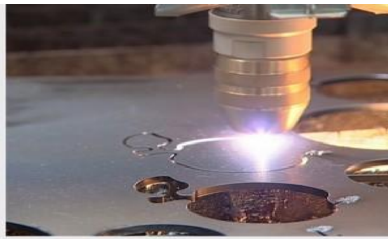
Εικόνα 24: Κοπή με πλάσμα
