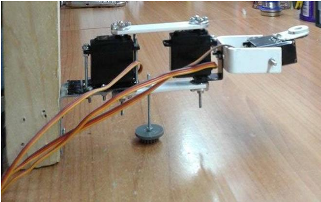
Εικόνα 3.2.7 Πλάγια όψη τροποποιημένου βραχίονα
