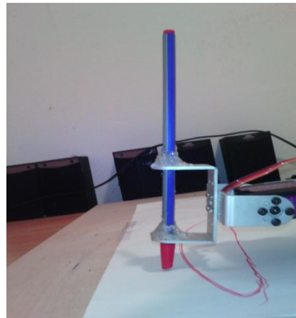
Εικόνα 3.2.14 Τοποθέτηση του στύλου
