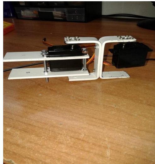
Εικόνα 3.2.5 Ένωση αλουμινίων σε σχήμα U
