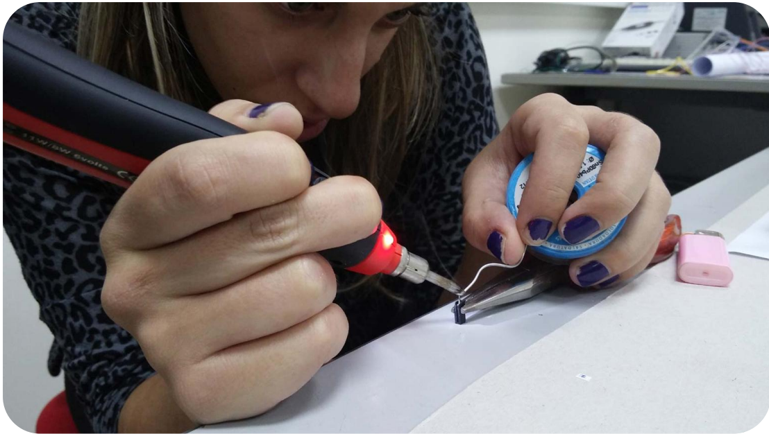
Κόλληση θηλυκού συνδέσμου για την προσαρμογή καλωδίου έτσι ώστε να εφαρμοστεί στον αντίστοιχο αρσενικό σύνδεσμο πάνω στον μικροελεγκτή
