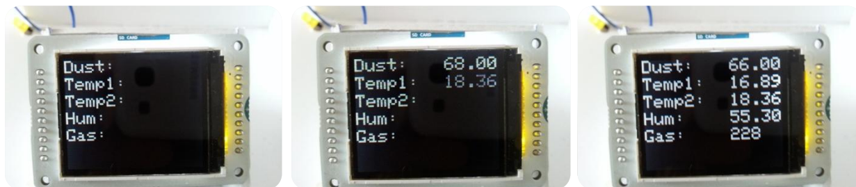
Ενδείξεις μετρήσεων πραγματικού χρόνου Σκόνης, Θερμοκρασίας, Υγρασίας & Καπνού
