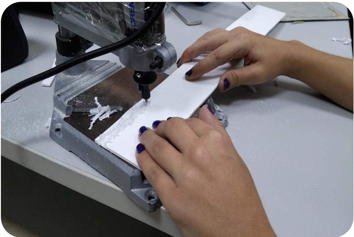
Διαδικασία για το άνοιγμα δρόμων οδήγησης των καλωδίων στα μακετόχαρτα (με τη χρήση Dremel) για το πέρασμα των καλωδίων
