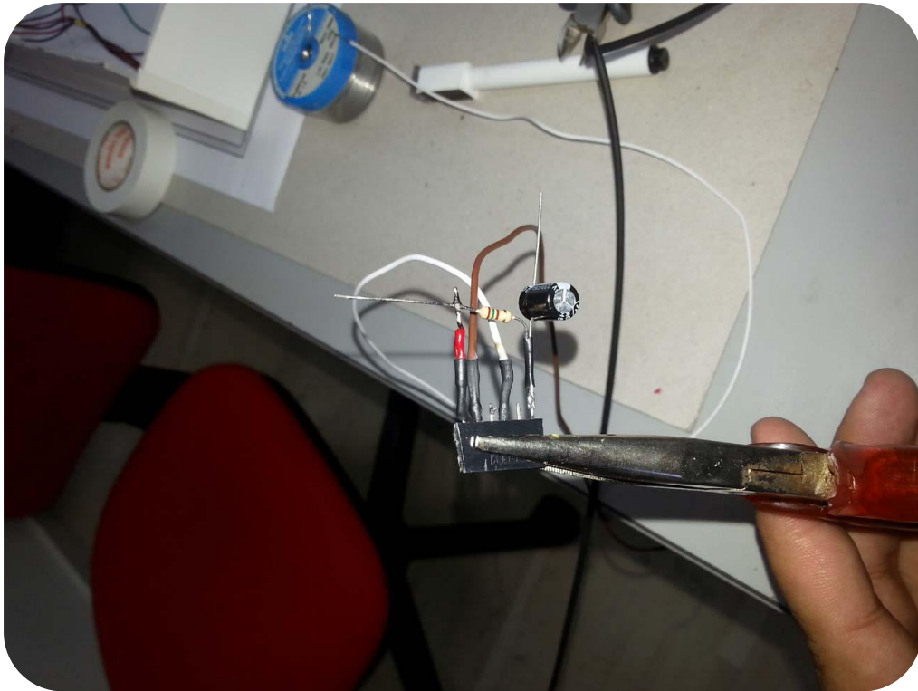
Κολλήσεις πάνω σε θηλυκούς συνδέσμους ηλεκτρονικών στοιχείων και καλωδίων, για τη σωστή λειτουργία του Dust sensor
