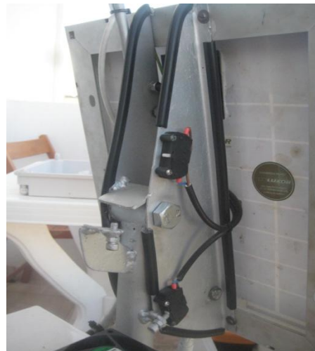
Σχήμα 30. α) Τερματοδιακόπτης αζιμουθίου πάνω στο υπερυψωμένο σίδερο β) Τερματοδιακόπτες κλίσης και μηχανικός διακόπτης.
