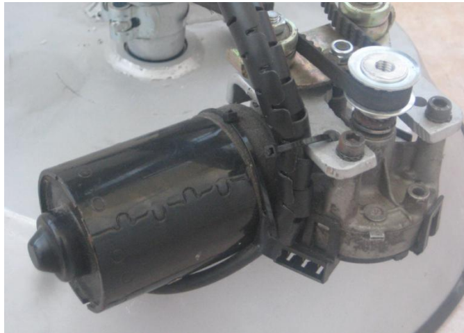
Σχήμα 28. Ο κινητήρας του αζιμούθιου του πραγματικού συστήματος.
