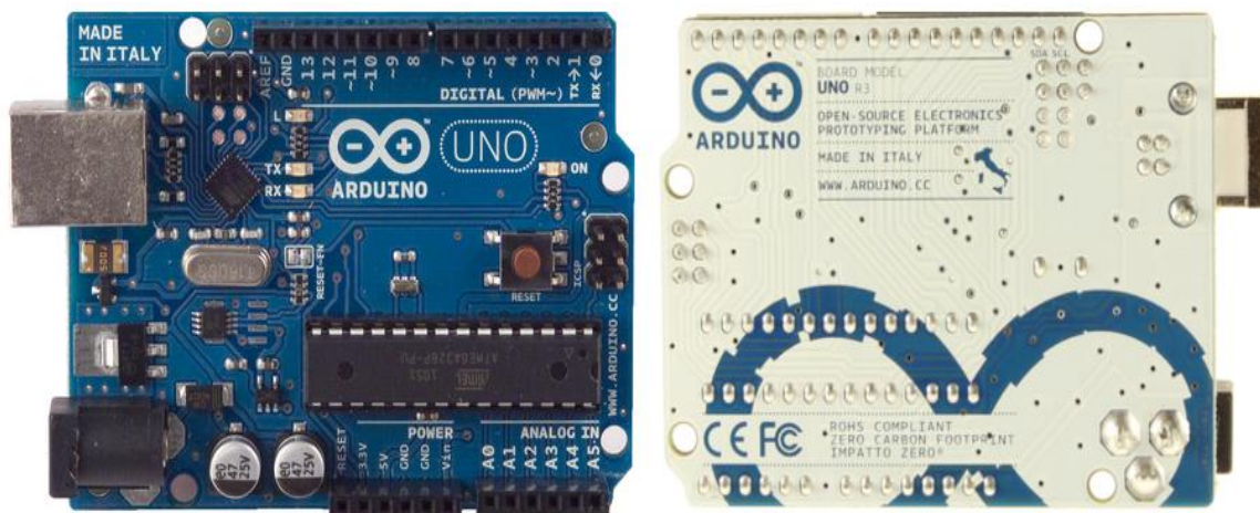
Σχήμα 22. Μπροστά (αριστερά) και πίσω (δεξιά) όψη πλακέτας Arduino.
