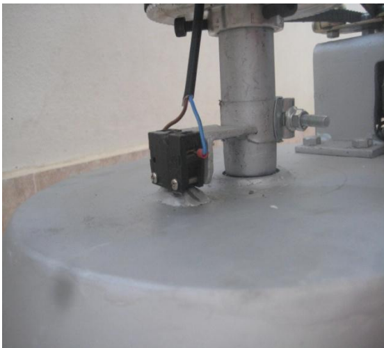
Σχήμα 30. α) Τερματοδιακόπτης αζιμουθίου πάνω στο υπερυψωμένο σίδερο β) Τερματοδιακόπτες κλίσης και μηχανικός διακόπτης.
