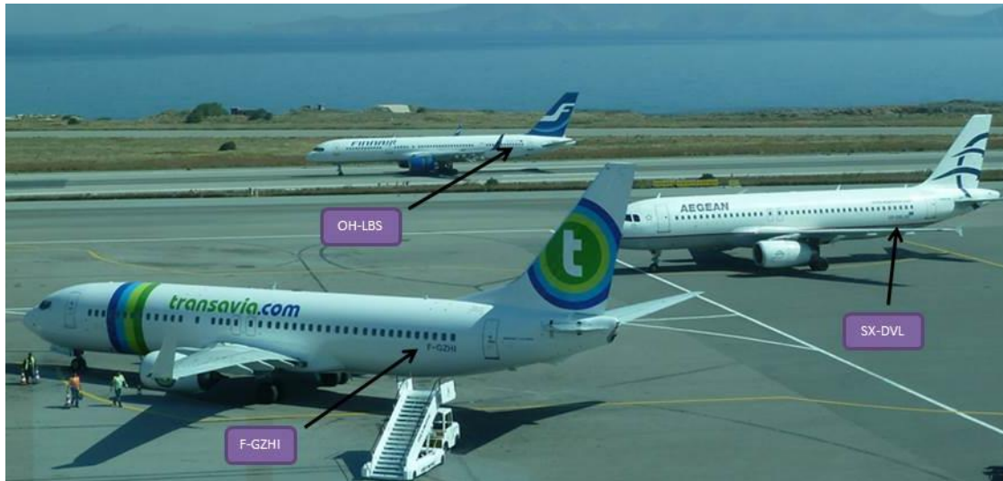
Εικόνα 17: Θέσεις αριθμών νηολογίου σε διαφορετικά αεροσκάφη
