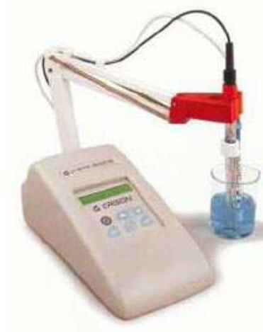
Εικόνα 3.1 φορητό πεχάμετρο AS-501 της Crison
