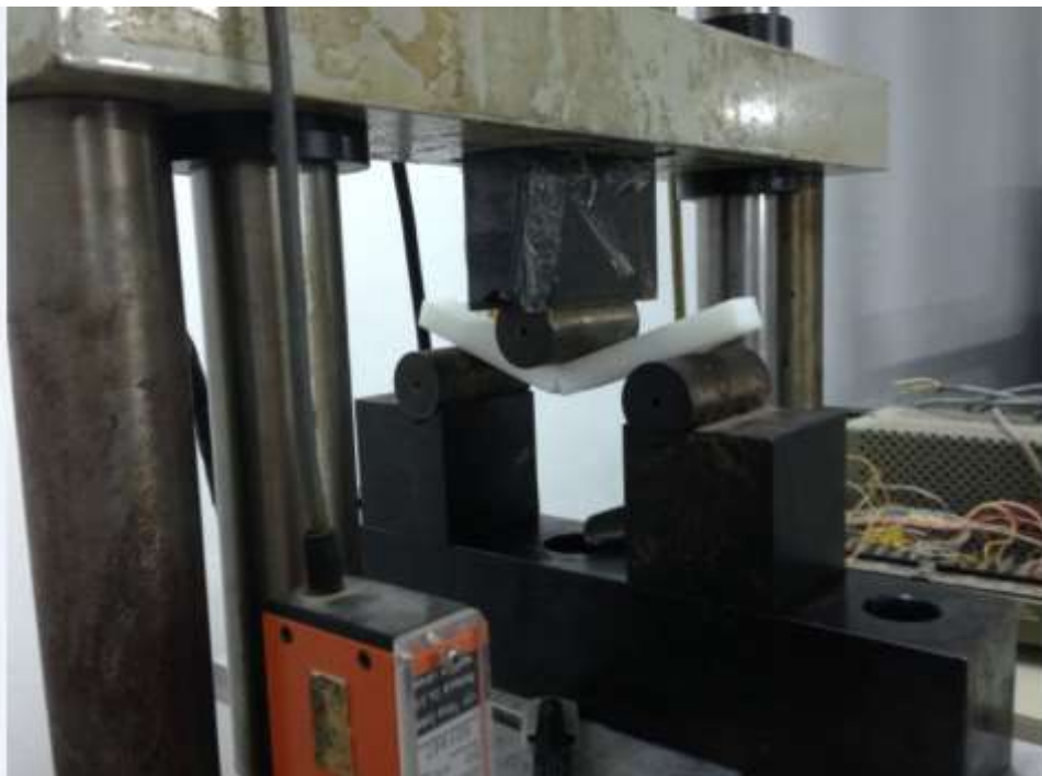
Εικόνα 45: Δοκίμιο abs plus κατά τη διάρκεια μέγιστης φόρτισης.
