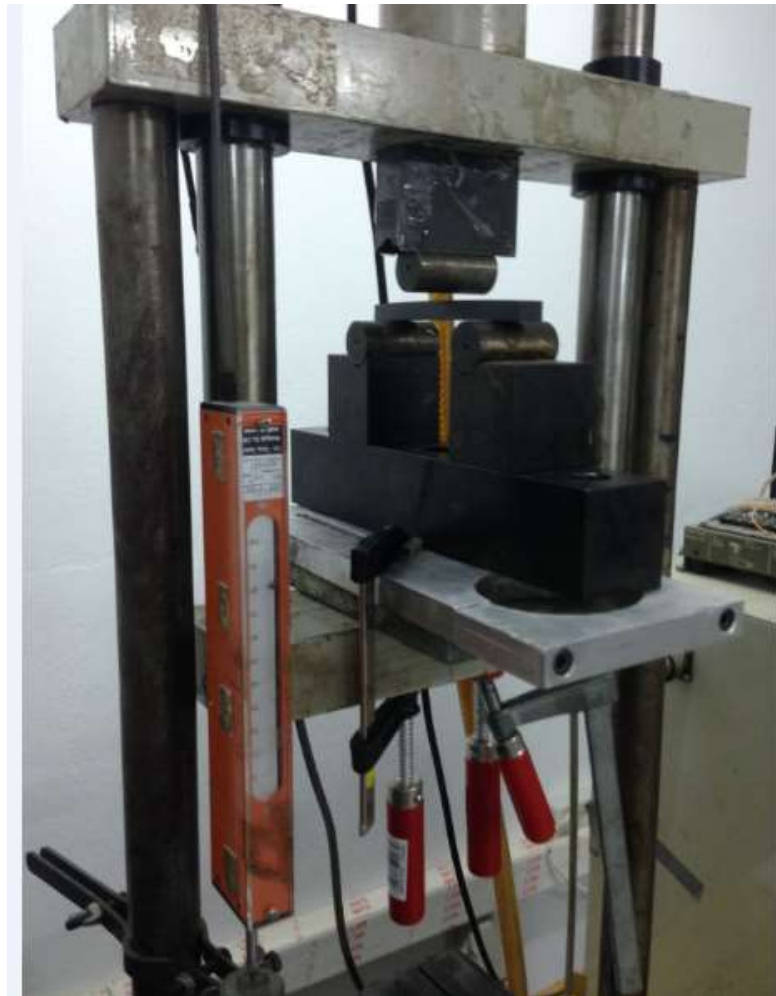
Εικόνα 46: Πορτοκαλί μηκηνσιόμετρο υπεύθυνο για τις μετρήσεις.
