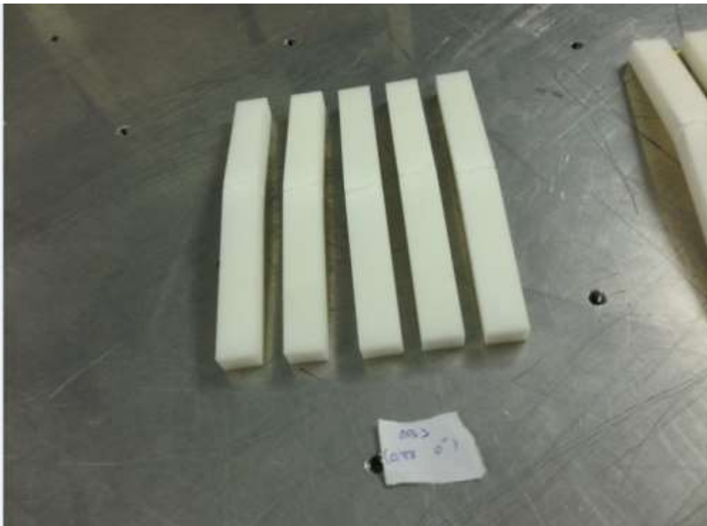
Εικόνα 48: Παράθεση δοκιμίων abs plus μετά το πείραμα κάμψης.
