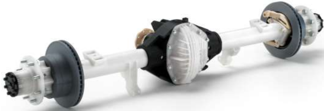
Εικόνα 13: Άξονας κατασκευασμένος από abs m30.
