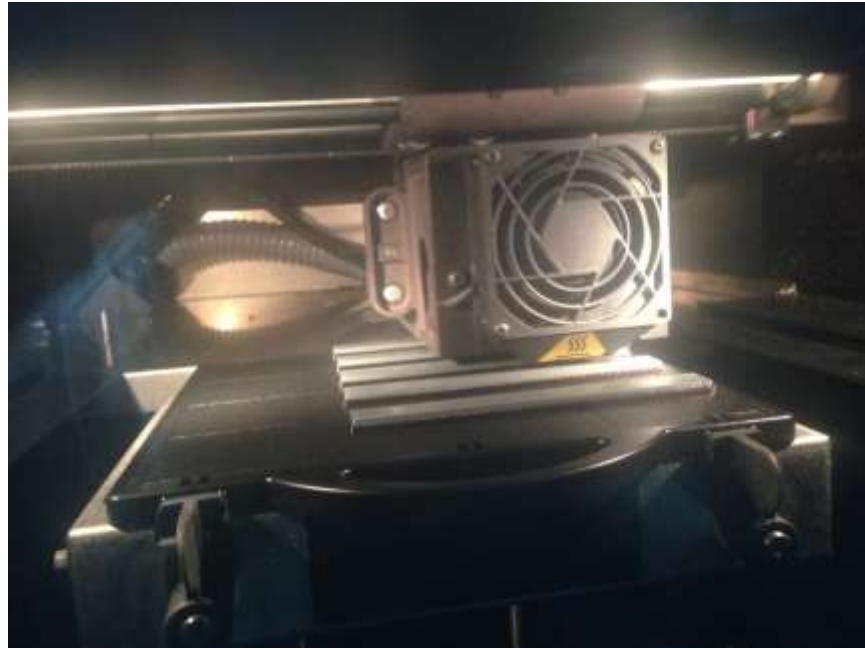
Εικόνα 39: Εκτύπωση δοκιμίων πτυχιακής abs plus με τη μέθοδο FDM.
