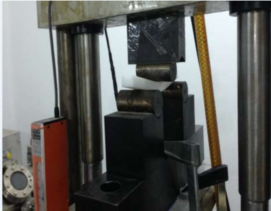
Εικόνα 44: Δοκίμιο abs plus κατά τη διάρκεια του πειράματος
