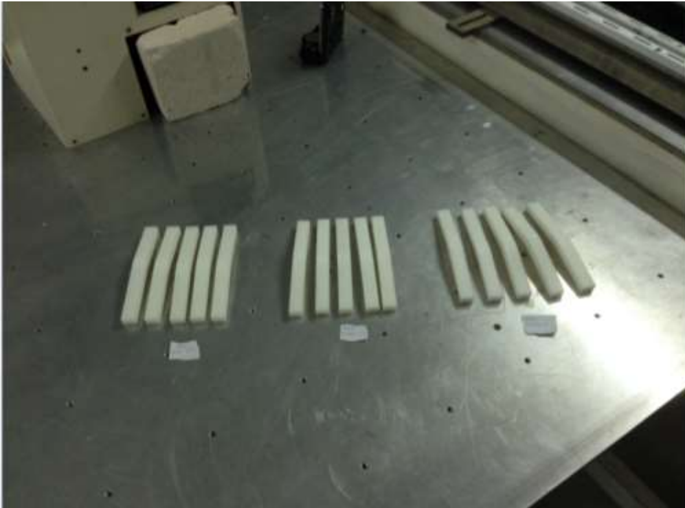
Εικόνα 47: Δοκίμια abs plus μετά το πείραμα κάμψης.
