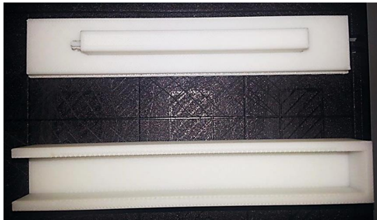
Εικόνα 3.9: Το καλούπι που χρησιμοποιήθηκε για την χύτευση της σιλικόνης αμέσως μετά την εκτύπωση του στον 3D Printer, elite της Dimension
