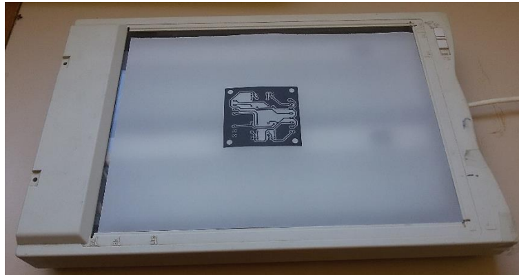
Εικόνα 4.10: Ειδική λάμπα για τον έλεγχο του εκτυπωμένου σχεδίου της πλακέτας Pcb
