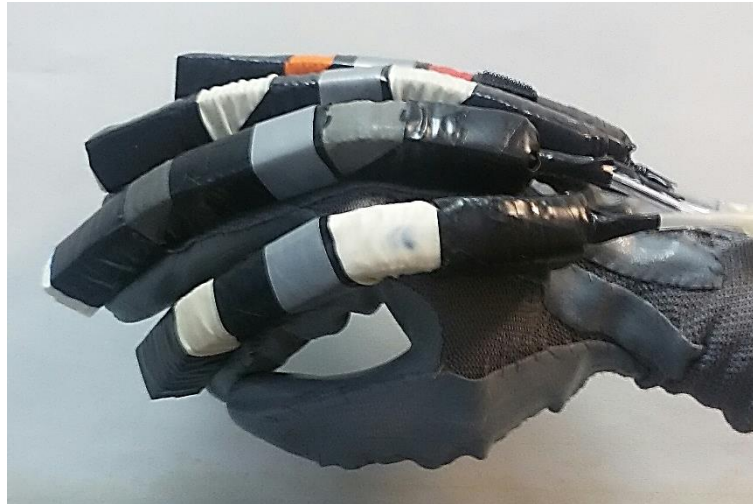
Εικόνα 2.9: Γάντι αποκατάστασης της κινηματικής των δαχτύλων του χεριού PneumaticGlove προσαρμοσμένο σε ανθρώπινο χέρι
