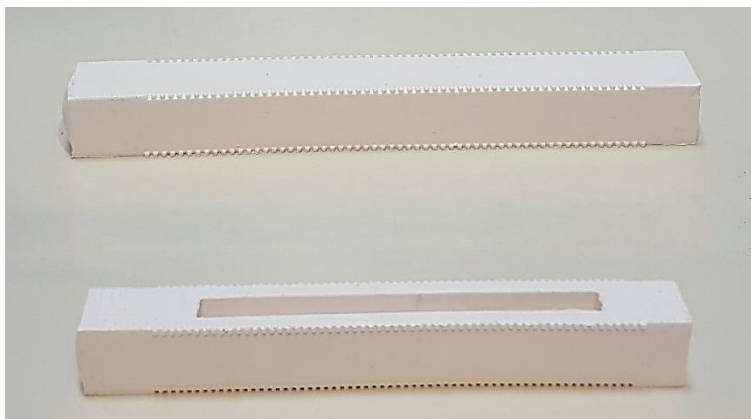
Εικόνα 3.15: Το σχήμα που παίρνει η σιλικόνη από το καλούπι και από τις δύο πλευρές για να φανεί ο θάλαμος για τον αέρα
