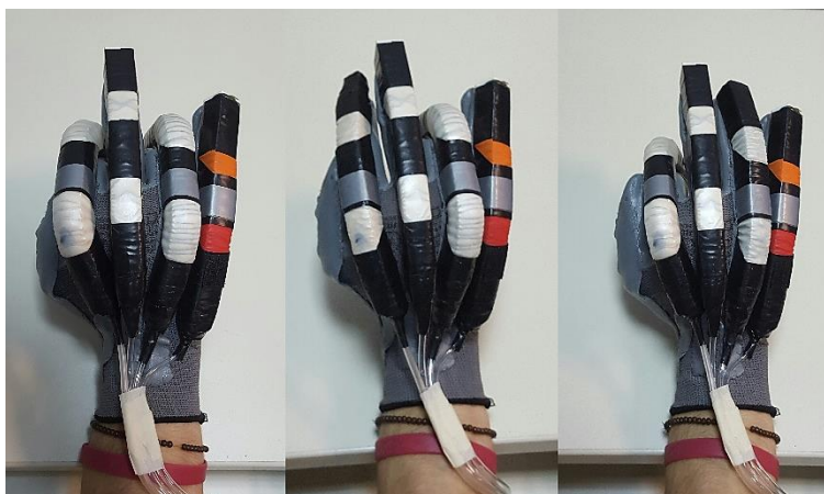
Εικόνα 5.6: Ο εξωσκελετικός νάρθηκας σε κίνηση έχοντας επιλέξει ο χρήστης κάθε φορά ποιο δάχτυλο θα κλείνει μέσω της χειροκίνητης λειτουργίας (Manual mode)
