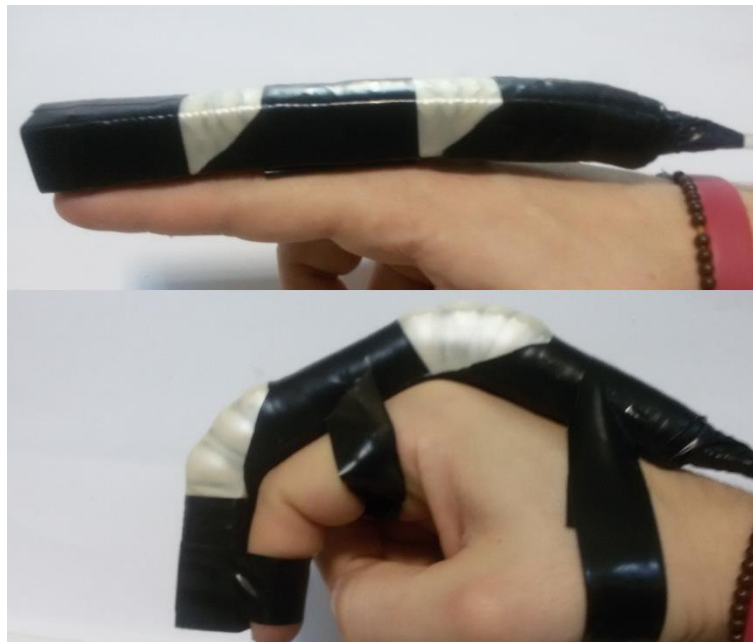
Εικόνα 3.23: Παρατηρούμε εδώ το εξωσκελετικό δάχτυλο και την κίνηση του μετά από την τροποποίηση που έχει γίνει
