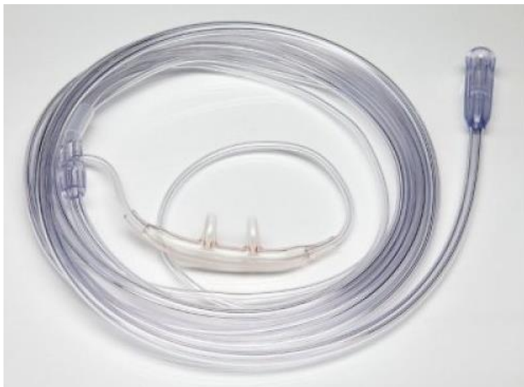
Εικόνα 3.8: Το μαλακό σωληνάκι ορού που χρησιμοποιήθηκε για την παροχή αέρα στους πνευματικούς επενεργητές
