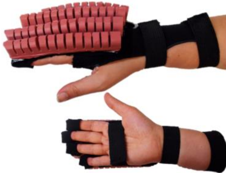
Εικόνα 2.8: Γάντι αποκατάστασης χεριού προσαρμοσμένο σε ανθρώπινο χέρι
