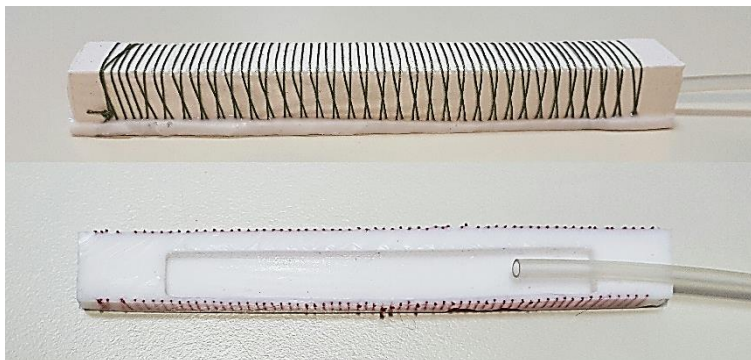
Εικόνα 2.5: Ο επενεργητής τύπου PneuFlex. Στην κάτω εικόνα φαίνεται πως είναι σε τομή
