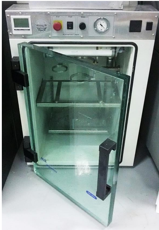
Εικόνα 3.14: Ο θάλαμος κενού της Mk Technology μοντέλου Mk-mini, του εργαστήριου Αυτοματικής και Ρομποτικής του ΤΕΙ Κρήτης
