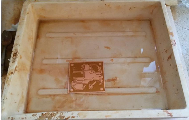
Εικόνα 4.12: Η πλακέτα στο μείγμα καυστικής σόδας
