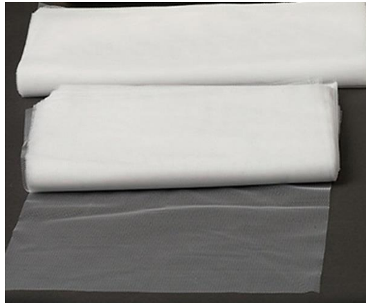
Εικόνα 3.17: Το τούλι που χρησιμοποιήθηκε στην κατασκευή του PneuFlex Actuator
