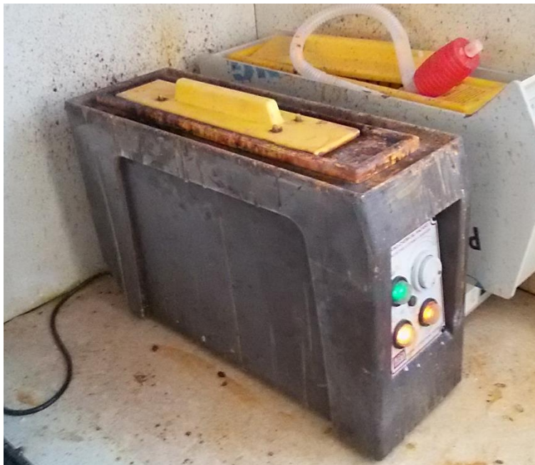
Εικόνα 4.13: Το μηχάνημα με το μείγμα χλωριούχου σιδήρου για την αφαίρεση του ανεπιθύμητου χαλκού από την πλακέτα
