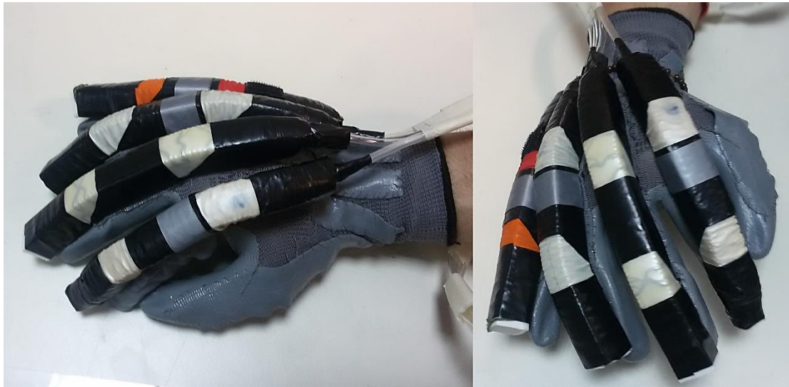
Εικόνα 3.1: Ο νάρθηκας αποκατάστασης (PneumaticGlove), με τους επενεργητές τύπου PneuFlex (τροποποιημένους) προσκολλημένους πάνω του
