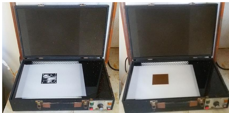
Εικόνα 4.11: Το εκτυπωμένο σχέδιο πάνω στο ειδικό μηχάνημα έκθεσης υπεριώδους ακτινοβολίας UV
