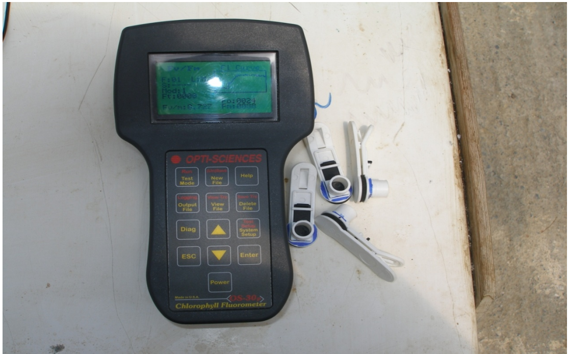
Εικόνα 4.20: Φθορίμετρο, opti-sciences OS-30r, UK και τα ειδικά 'μανταλάκια'.
