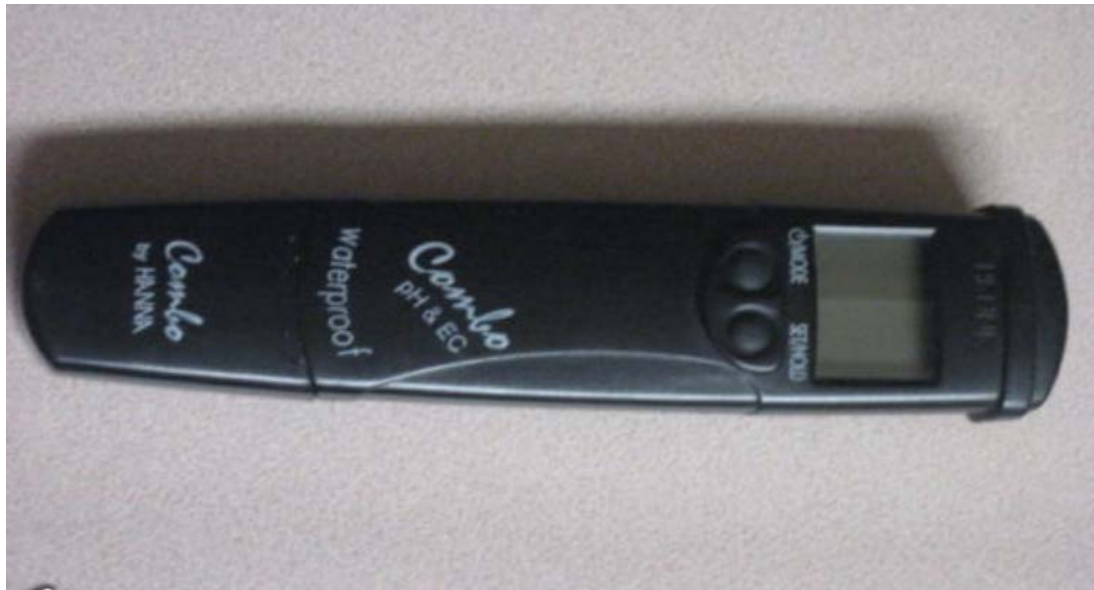
Εικόνα 4.16: Φορητό πεχάμετρο και αγωγιμόμετρο (Hanna HI 98130).
