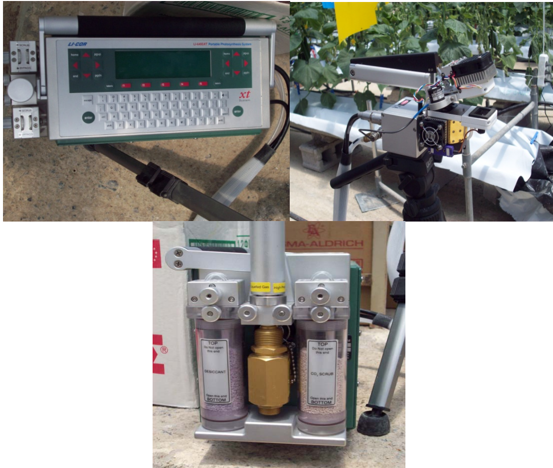
Εικόνα 4.21: Φορητή συσκευή υπέρυθρης ανάλυσης αερίων (model LI-6200, Li-Cor, Inc., Lincoln, NE).
