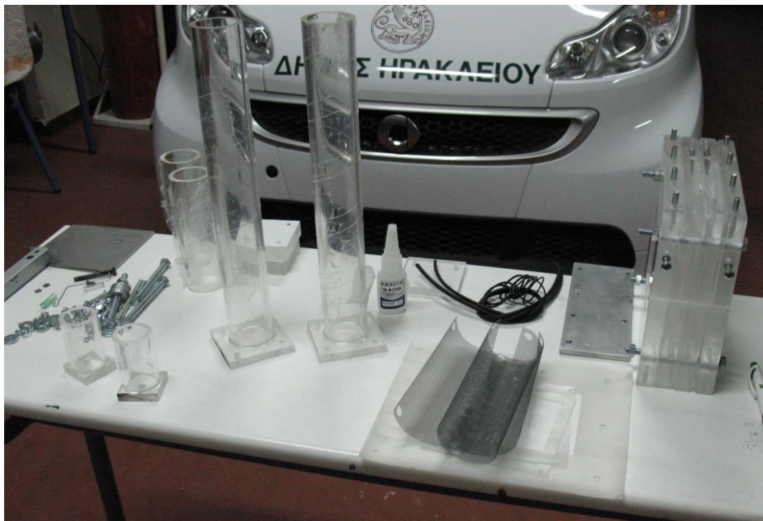
Εικόνα 5. Κοπή & Συγκόλληση Δοχείων Αποθήκευσης των παραγόμενων Αερίων ( H_2 & O )
