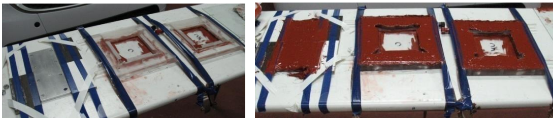
Εικόνα 6. Συγκόλληση Γυαλιών & Κατασκευή φλαντζών με την κόκκινη σιλικόνη
