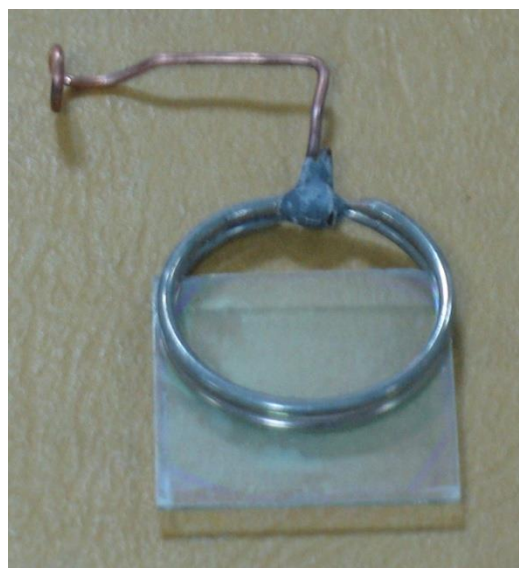
Εικόνα 23 Ηλεκτρόδιο 1\text{in}^2 με το σύνδεσμο συγκράτησης για τη μικρή ΦΗΧ Κυψελίδα
