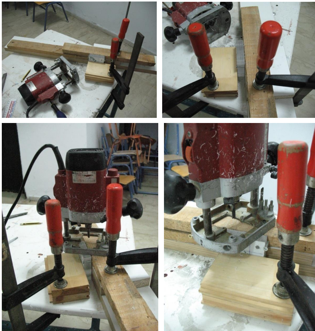
Εικόνα 2. Τοποθέτηση -II- Router κοπή με το εργαλείο: Κονδύλη Σκαλίσματος 6 mm
