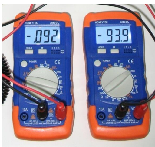
Εικόνα 78 Τοποθέτηση μεταγωγικού διακόπτη στα πολύμετρα για ανάληψη μετρήσεων
