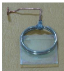
Εικόνα 7. Ηλεκτρόδιο \text{in}^2 με το σύνδεσμο συγκράτησης για την μικρή ΦΗΧ Κυψελίδα
