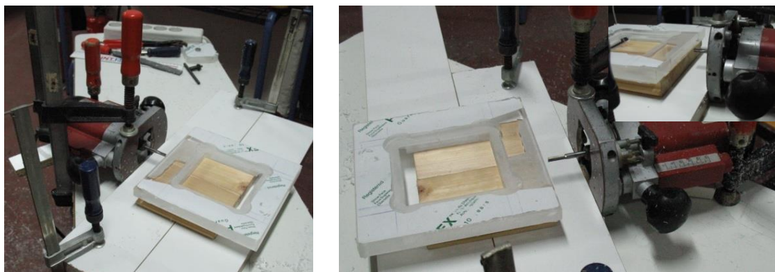
Εικόνα 2. Τοποθέτηση -II- Router κοπή με το εργαλείο: Κονδύλη Σκαλίσματος 6 mm
