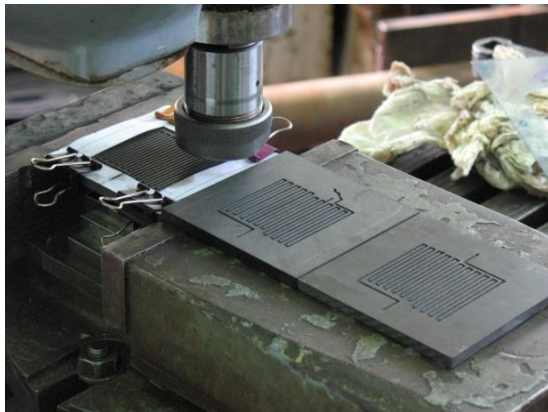
Εικόνα 6. Ολοκλήρωση Σκαλίσματος (1η πλευρά)
