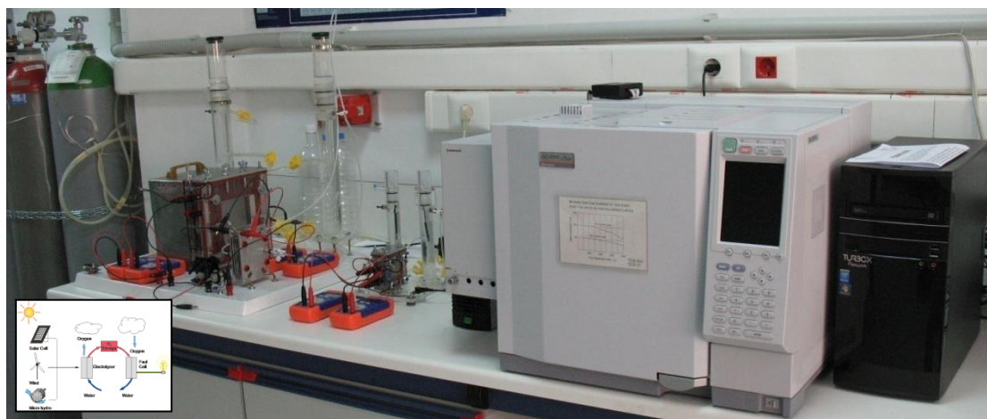
Εικόνα 69 Διάταξη Φωτοηλεκτροχημικών Μονάδων και PEM Κυψέλης Καυσίμου στο χώρο του Εργαστηρίου με τον Ανιχνευτή Αέριας Χρωματογραφίας
