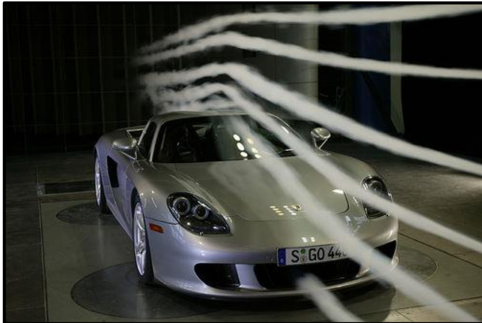
Εικόνα 8.7 Εμφάνιση γραμμών ροής με χρήση καπνού.
