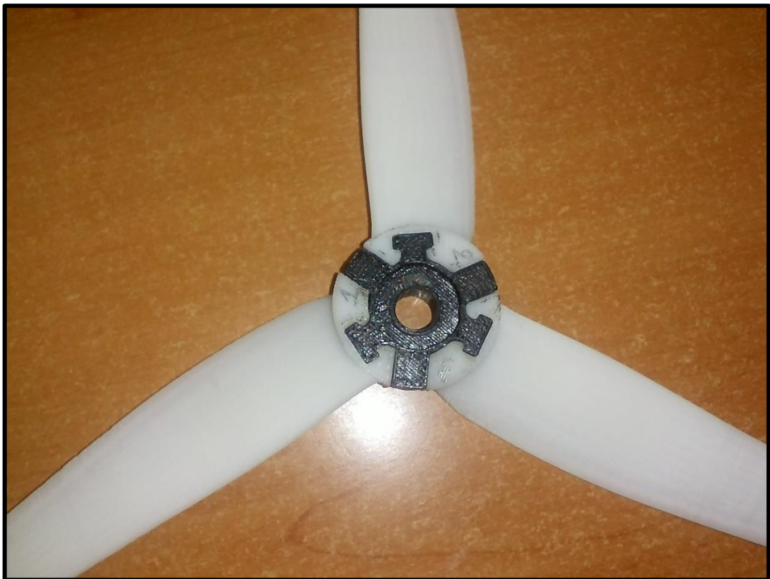
Εικόνα 7.8 Πλήμνη με τα φτερά συναρμολογημένα
