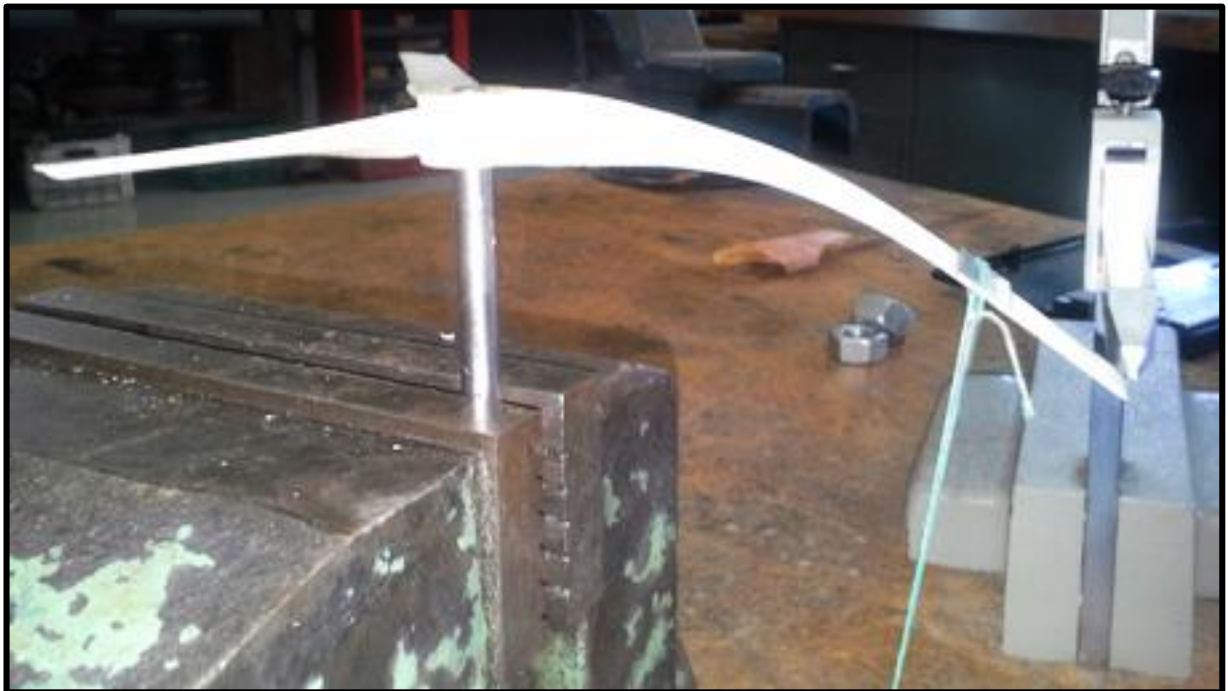
Εικόνα 7.12 Δοκιμή φτερού σε κάμψη
