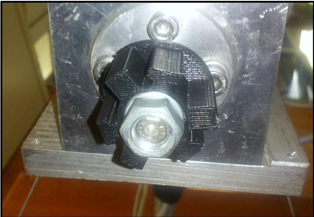
Εικόνα 7.5 Η εκτυπωμένη πλήμνη τοποθετημένη στην πειραματική εγκατάσταση.
