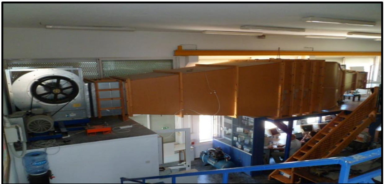
Αεροσήραγγα Εργαστηρίου Αιολικής Ενέργειας
