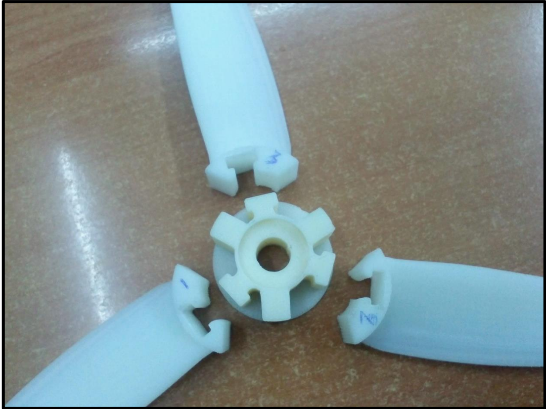
Εικόνα 7.7 Πλήμνη με τα φτερά πριν την συναρμολόγηση
