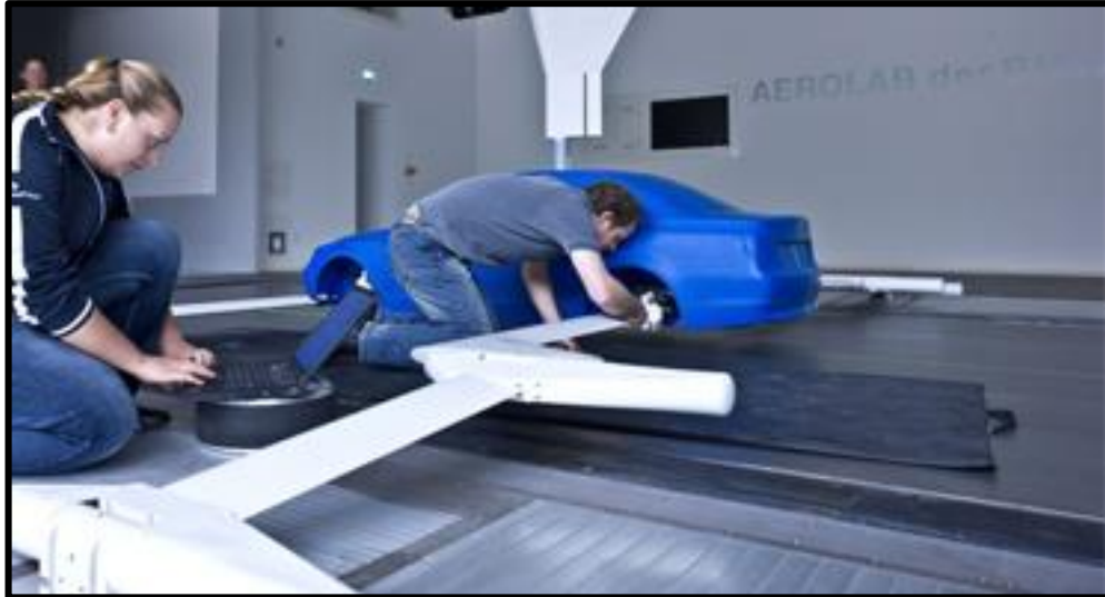
Εικόνα 8.1 Κατασκευή μοντέλου για αεροδυναμικές μετρήσεις.
