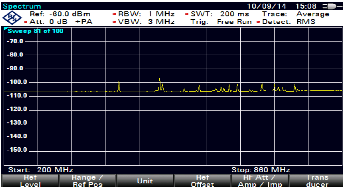
Οθόνη του αναλυτή φάσματος κατά την μέτρηση στην Υ κατεύθυνση της κεραίας λήψης
