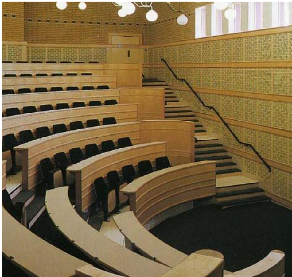
Εικόνα 4.16 Αέρας εισέρχεται στο χώρο του αμφιθεάτρου μέσω ολομέλειας υπό τα κεκλιμένα καθίσματα
