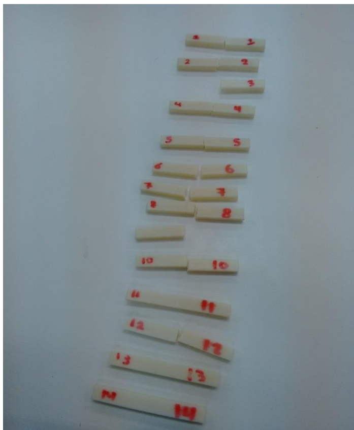
Εικόνα 6.18: Δοκίμια χωρίς ρωγμή μετά την δοκιμή τους σε κρούση με τη σφύρα .
