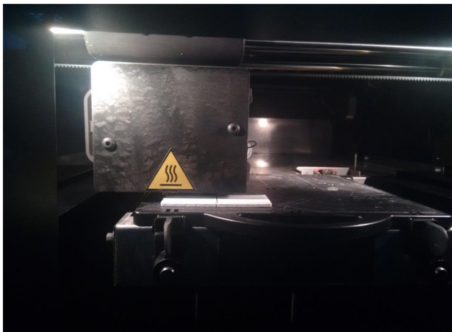
Εικόνα 6.15: Εκτύπωση με εναπόθεση ABS υλικού στο Dimension BST 768 εκτυπωτή μετά την τοποθέτηση του γκρί support υλικού.
