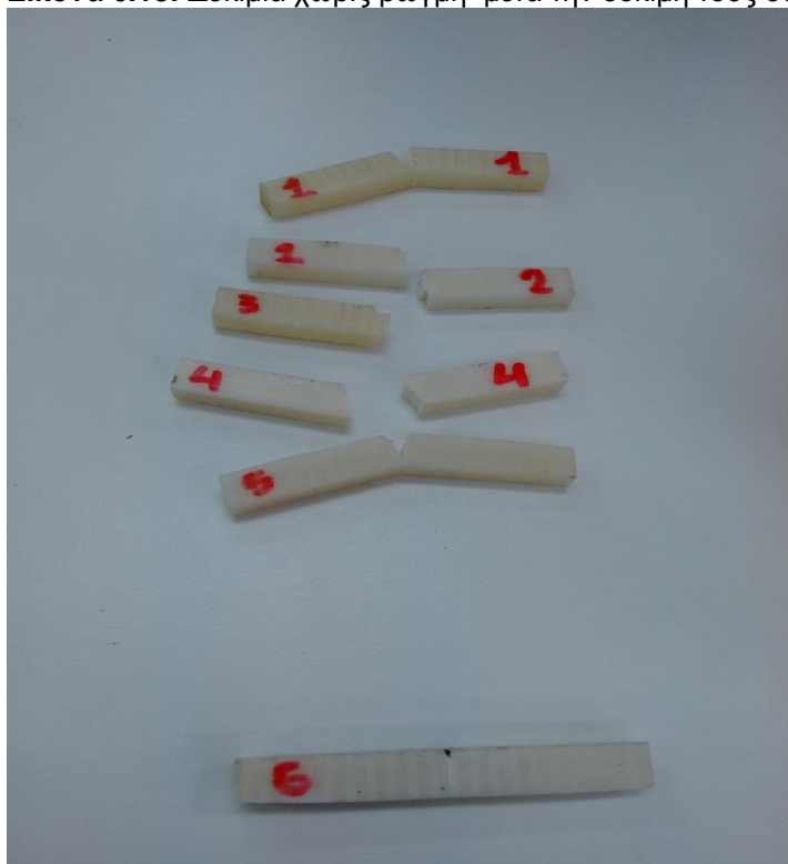
Εικόνα 6.19: Δοκίμια με ρωγμή στη μέση μετά τη δοκιμή τους σε κρούση .
