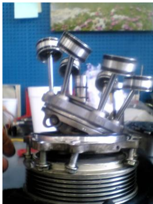
Σχήμα 1.9. : Περιστροφικός συμπιεστής μεταβλητού όγκου χωρίς μαγνητικό συμπλέκτη εξωτερικά ελεγχόμενο
