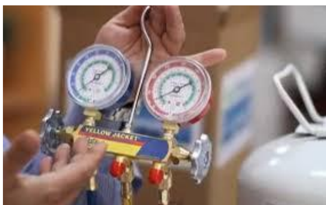
Σχήμα 5.1. : Ίδιες πιέσεις (χαμηλή - υψηλή).
