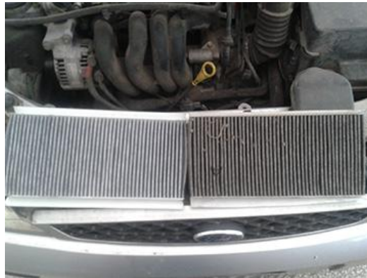
Σχήμα 7.1.. : Καθαρισμός και αντικατάσταση φίλτρων κλιματισμού.
