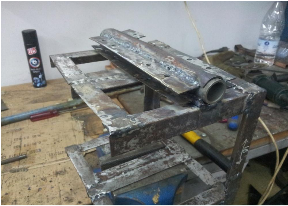
Εικόνα 35: τρόπος συγκράτησης της βάσης
