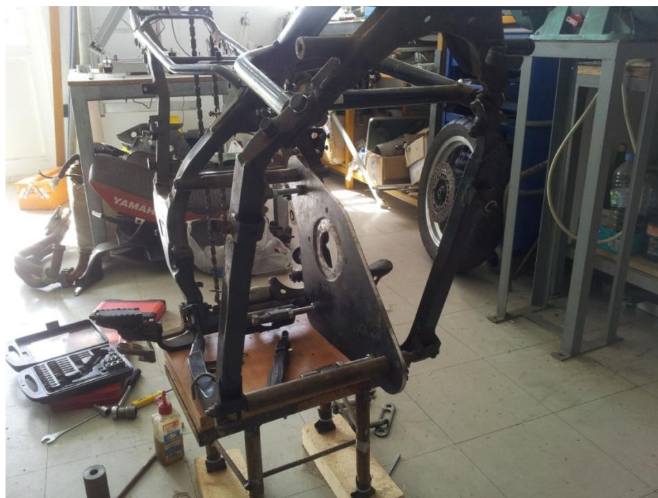
Εικόνα 27: η βάση τοποθετημένη στον σκελετό
