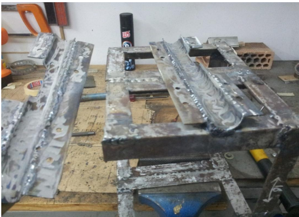
Εικόνα 34: ένας από τους δύο τρόπους συγκράτησης της βάσης των μπαταριών
