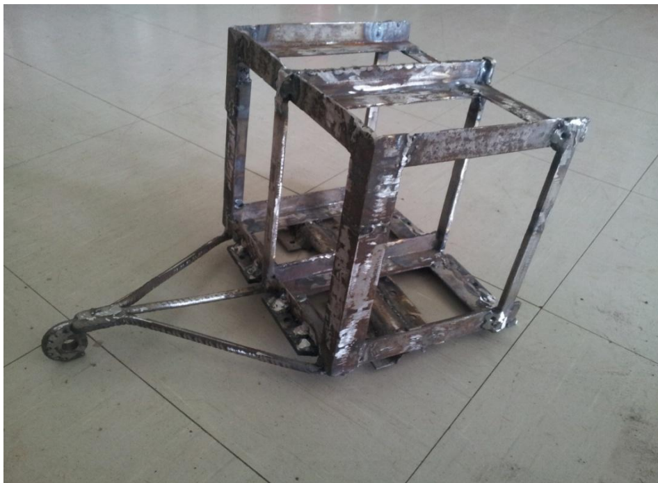
Εικόνα 33: βάση μπαταριών κατασκευασμένη με τα σημεία στήριξης
