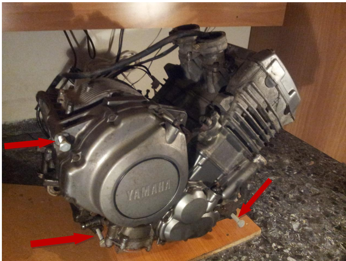
Εικόνα 23: τα τρία σημεία στήριξης του κινητήρα MEK
