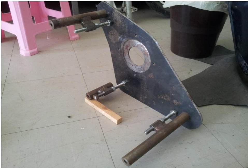
Εικόνα 25: βάση ηλεκτροκινητήρα και οι κύλινδροι στήριξης εκτός σκελετού
