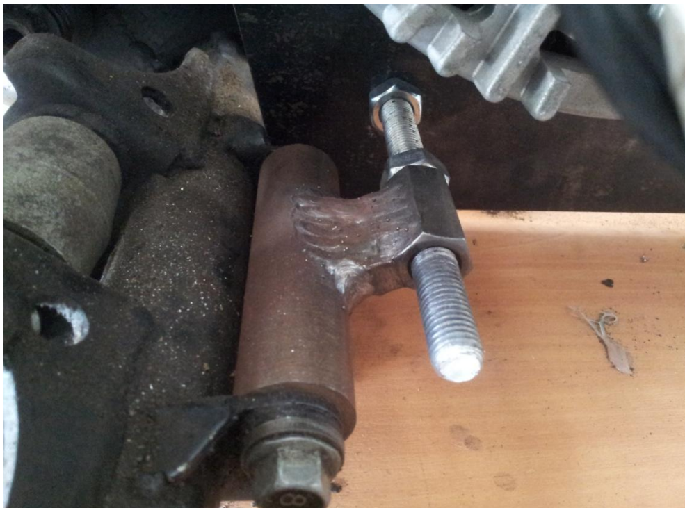
Εικόνα 28: στήριξη του τρίτου σημείου της βάσης
