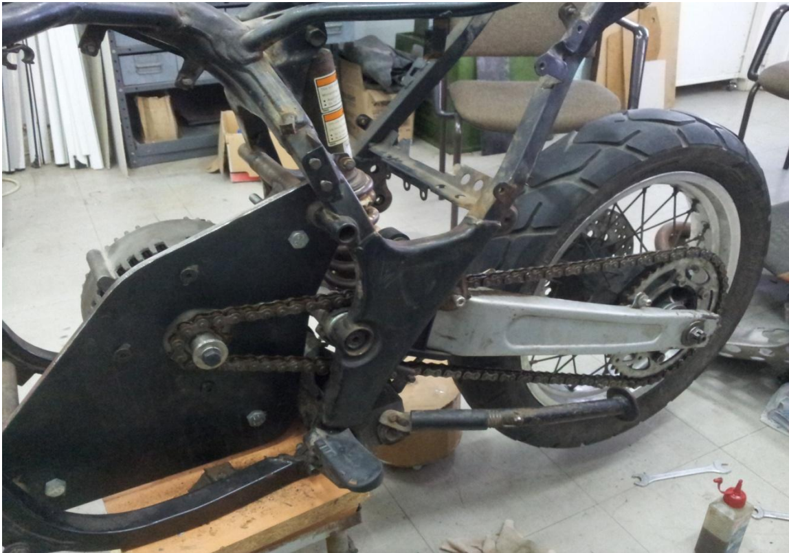
Εικόνα 21: κινητήριο γρανάζι 10 δοντιών και εργοστασιακό γρανάζι τροχού 46 δοντιών με την εργοστασιακή αλυσίδα.
