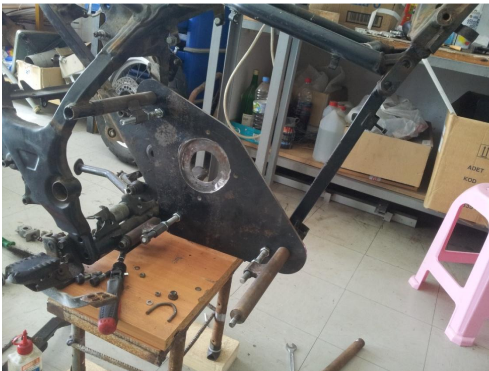
Εικόνα 26: βάση πάνω στον σκελετό με ένα από τα δύο πλαϊνά 'νεύρα' του σκελετού αφαιρεμένο
