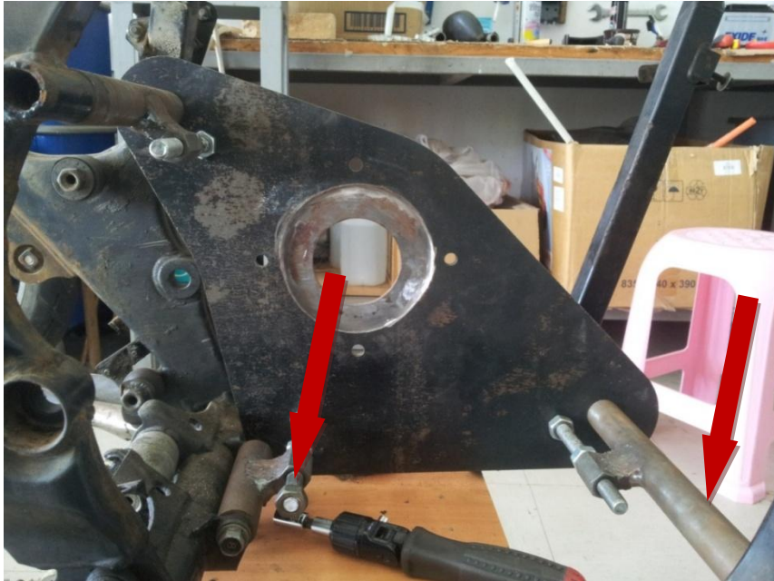
Εικόνα 29: τα δύο σημεία στήριξης της βάσης των μπαταριών
