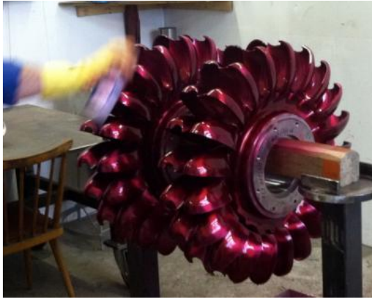
α) πτερύγια δρομέα στροβίλου τύπου Pelton
