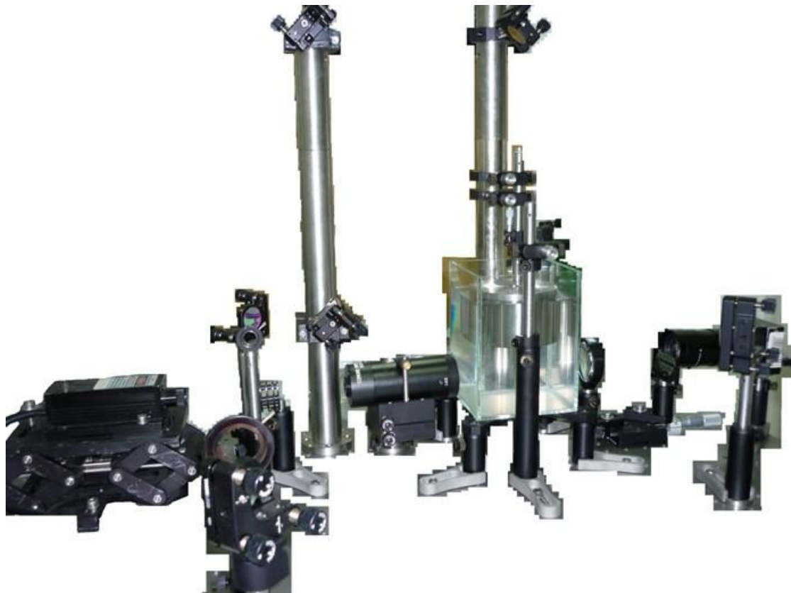
Σχήμα 18: Σχηματική αναπαράσταση (πάνω) και φωτογραφία (κάτω) της πειραματικής διάταξης ανίχνευσης schlieren που αναπτύχθηκε (οι επεξηγήσεις των διαφόρων μερών δίνονται στο κείμενο).
