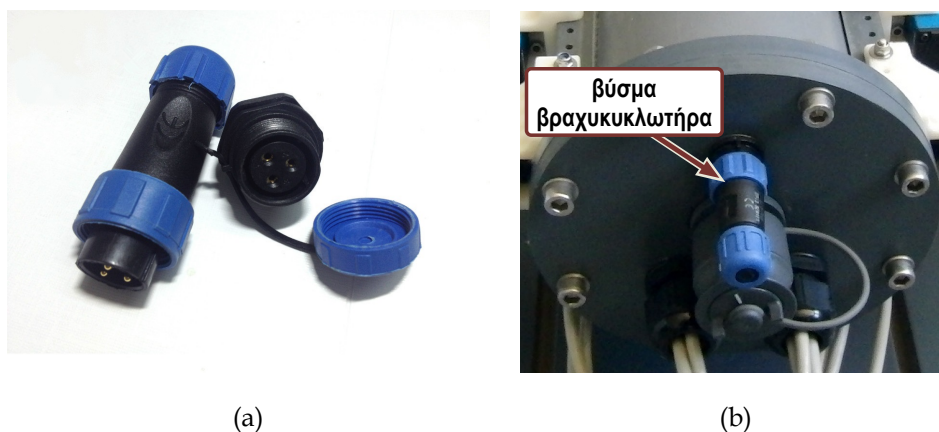
Σχήμα 3.10: (a) Το σύστημα αδιάβροχης ηλεκτρικής σύνδεσης τριών ακροδεκτών της εταιρίας Weipu (σειρά SP13) που χρησιμοποιείται για την εξωτερική τροφοδοσία και τη φόρτιση της μπαταρίας στο ρομποτικό πρωτότυπο. (b) Το τροποποιημένο βύσμα καλωδίου, το οποίο χρησιμοποιείται ως τερματικό στεγάνωσης και διακόπτης on/off του οχήματος.
