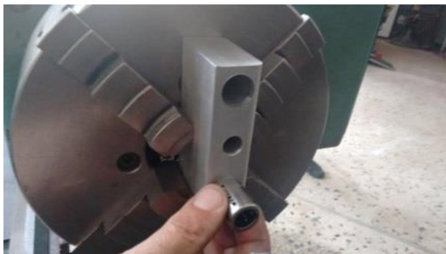
Εικόνα 3.11 Επεξεργασία της βάσης για ρουλεμάν σε τόρνο
