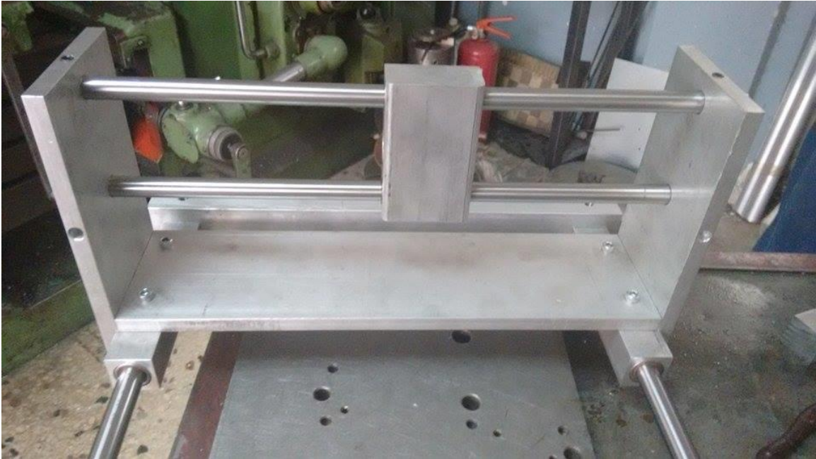
Εικόνα 4 Τοποθέτηση αξόνων στον Υ άξονα
