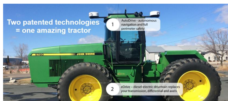
Εικόνα 6 αυτόνομο τρακτέρ με ενσωματωμένο πλοηγό
