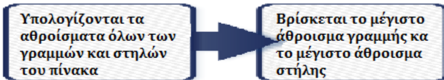
Εικόνα 4.5: Βήματα για την εύρεση της θέσης του κέντρου του αντικειμένου στην εικόνα.
