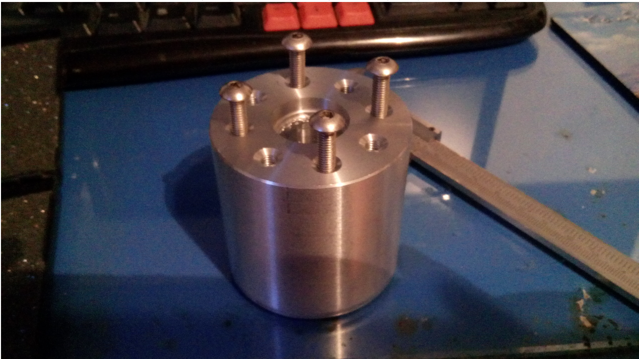
Εικόνα 6.5: Το τελικό έδρανο των ρουλεμάν. Διακρίνεται η έδρα του μονόσφαιρου ρουλεμάν, στην πλευρά που συνδέεται επάνω στη βάση του ρομπότ.
