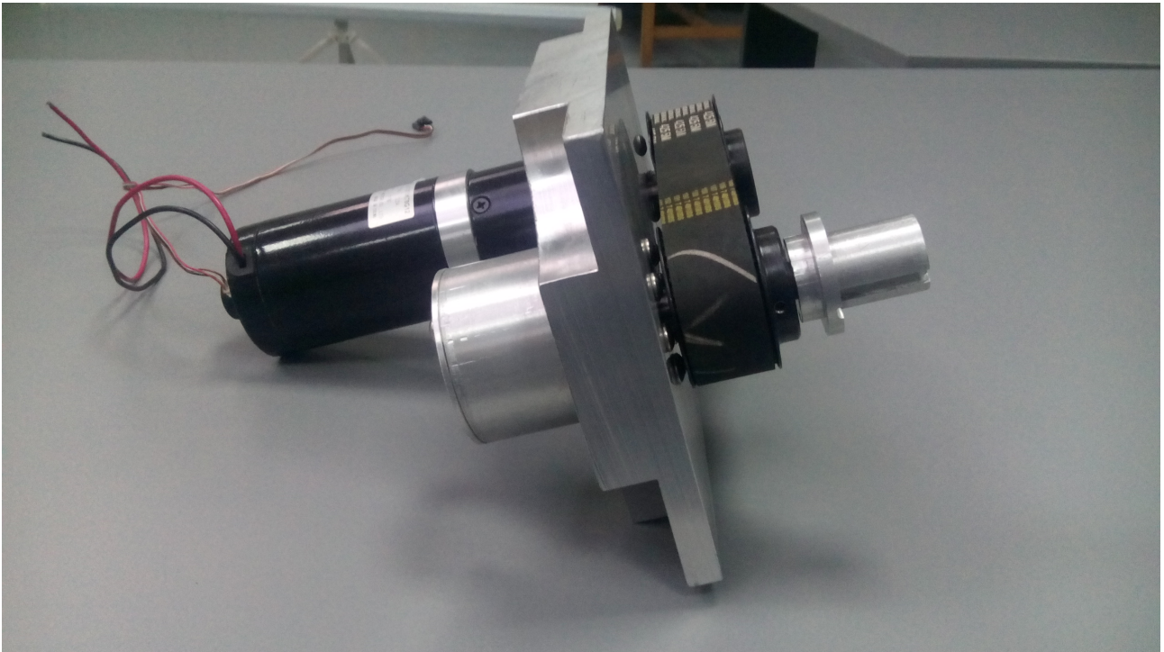
Εικόνα 6.6: Η βάση με το έδρανο του ρουλεμάν και τον κινητήρα συναρμολογημένα.
