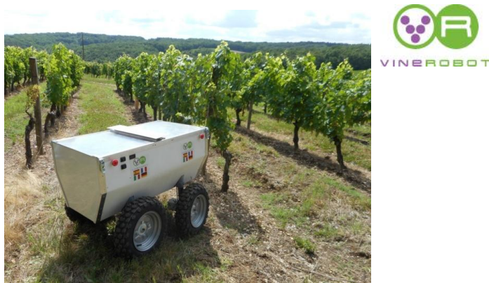
Εικόνα 1.2 Ρομποτική πλατφόρμα αυτόματης ανιχνευτής ποιότητας και ωρίμανσης σε αμπελώνα.
