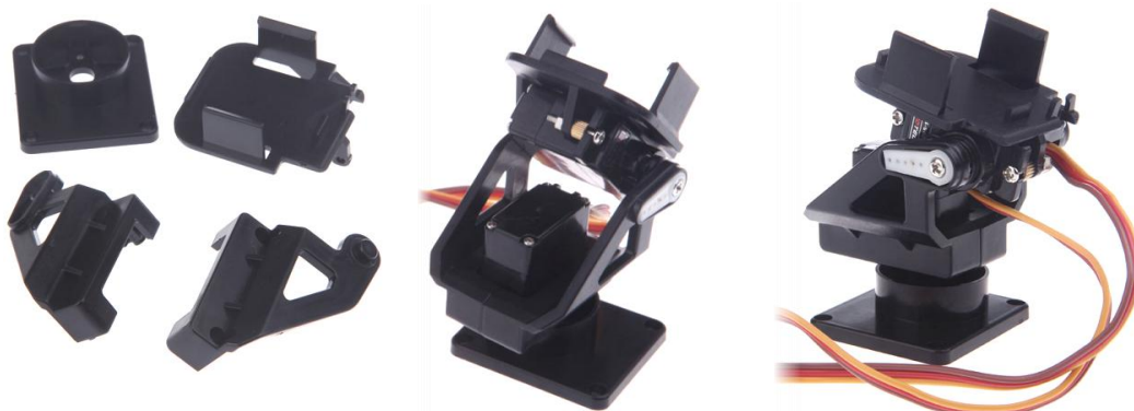
Εικόνα 6.1 Τα πλαστικά μέρη της διάταξης και δυο διαφορετικές όψεις του συναρμολογημένου μηχανισμού
