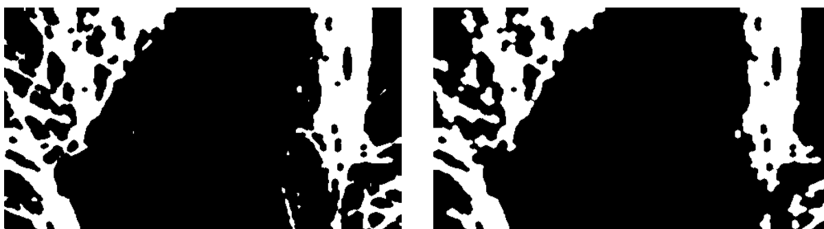
Εικόνα 6.40 Μορφολογική επεξεργασία α)λειτουργία closing β) λειτουργία opening
