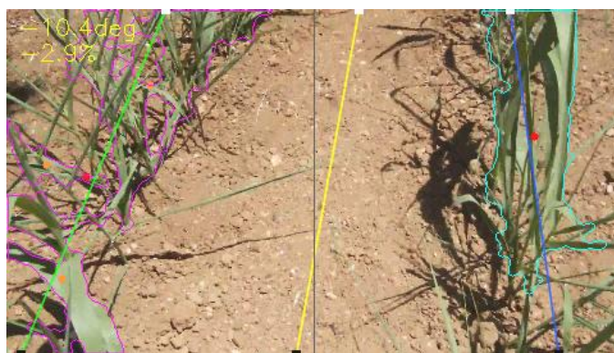
Εικόνα 6.49 Αποτύπωση στο ληφθέν στιγμιότυπο της κατευθυντήριας ευθείας στο μέσο του μονοπατιού και των πληροφοριών που σχετίζονται με αυτήν: κλίση σε μοίρες και απόσταση του κάτω άκρου της από την μέση %
