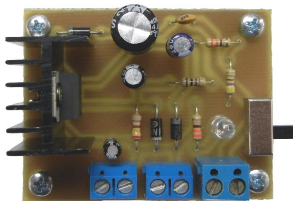
Εικόνα 3.8 DC σε DC μετατροπέας στα 5V με βάση τον γραμμικό σταθεροποιητής τάσης LM317 για την τροφοδοσία των μικροσερβοκινητήρων
