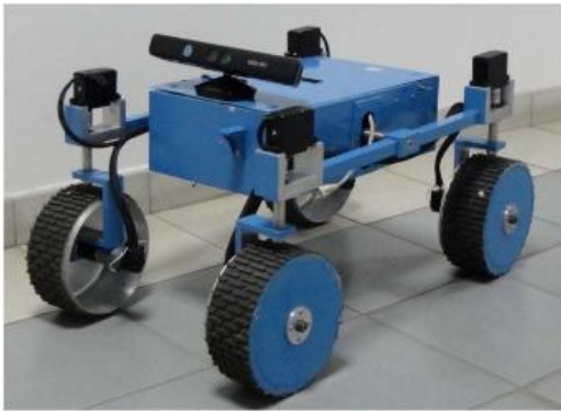
Εικόνα 1.20 Το ρόβερ Dune. Στο CAD μοντέλο απεικονίζονται τα βασικά δομικά μέρη του συστήματος ανάρτησης.
