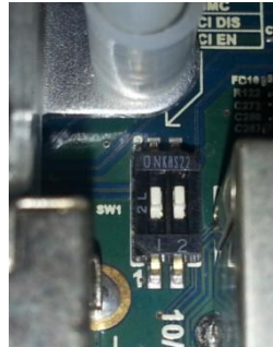
Εικόνα 6.13 Ρύθμιση των θέσεων του dip switch για την επιλογή αποθηκευτικού μέσου εκκίνησης
