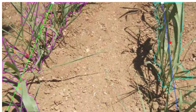
Εικόνα 6.46 Εμφάνιση των βοηθητικών ευθειών στην αριστερή και δεξιά πλευρά της εικόνας και των σημείων τομής των ευθειών με τα όρια της εικόνας (άνω άσπρα και κάτω μαύρα τετραγώνια)
