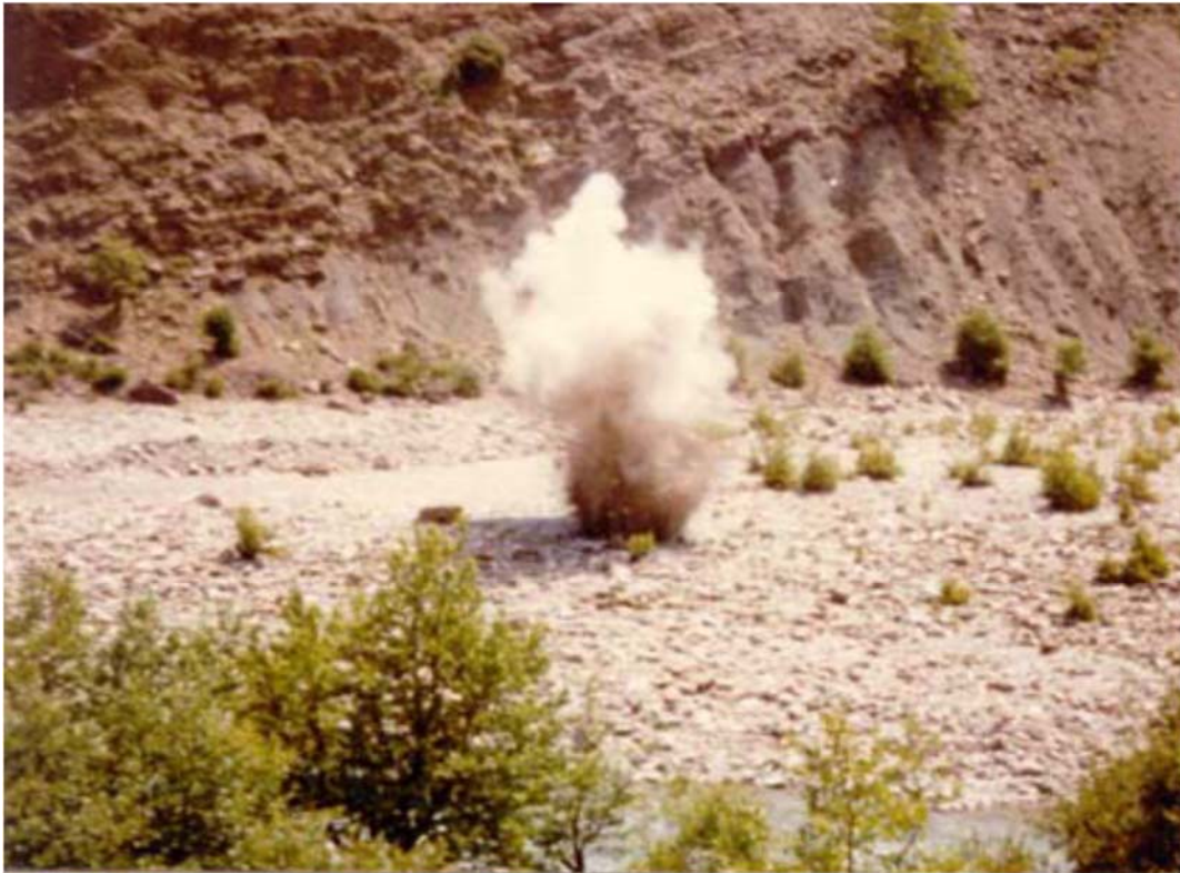
Σχήμα 3.22 Ενεργοποίηση σεισμικής πηγής με έκρηξη δυναμίτη σε πείραμα σεισμικής διάθλασης στη κοίτη του ποταμού Εύηνου (Φράγμα Αγ. Δημητρίου, 1996) [Ιωάννης Φ. Λούης, 2004].
