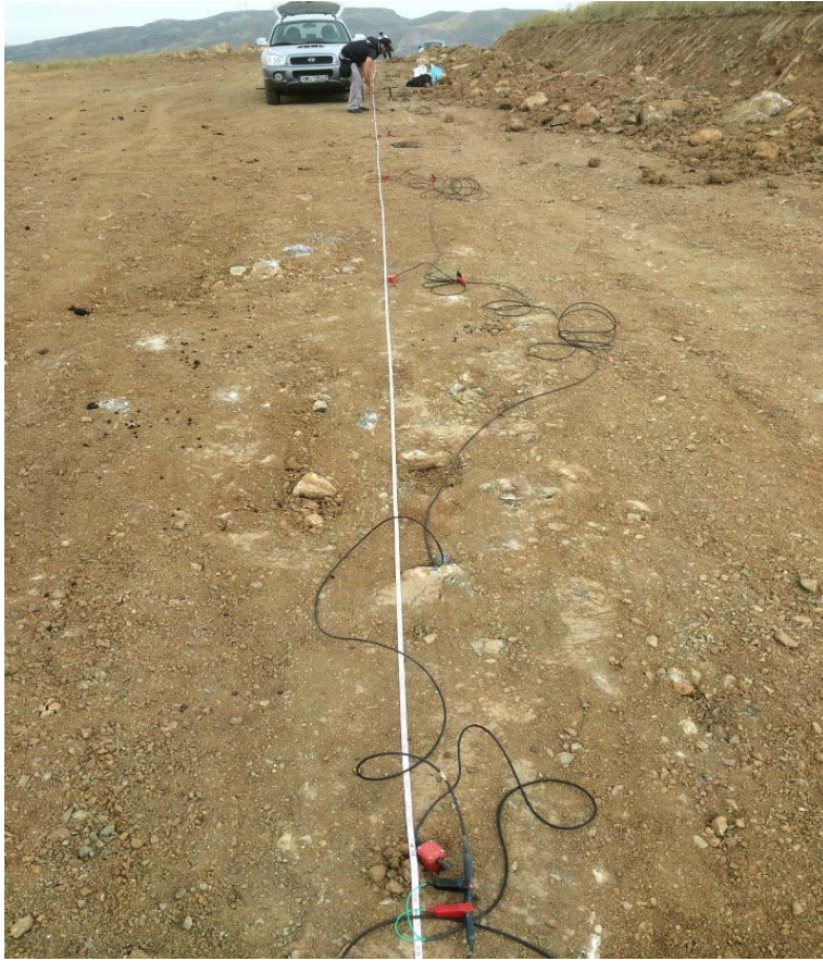
Σχήμα 3.28 Γεωφυσικό συνεργείο του Εργαστηρίου Γεωφυσικής και Σεισμολογίας του ΤΕΙ Κρήτης σε εργασία αναπτύγματος γραμμής γεωφώνων σε πλάτωμα της ευρύτερης περιοχής της Μονής Αγίου Γεωργίου Επανωσήφη.
