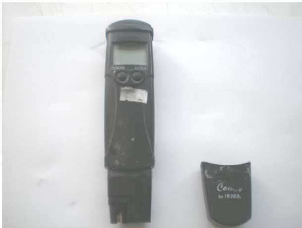
Εικόνα 4.10. Φορητό πεχάμετρο-αγωγιμόμετρο για την μέτρηση pH και EC.
