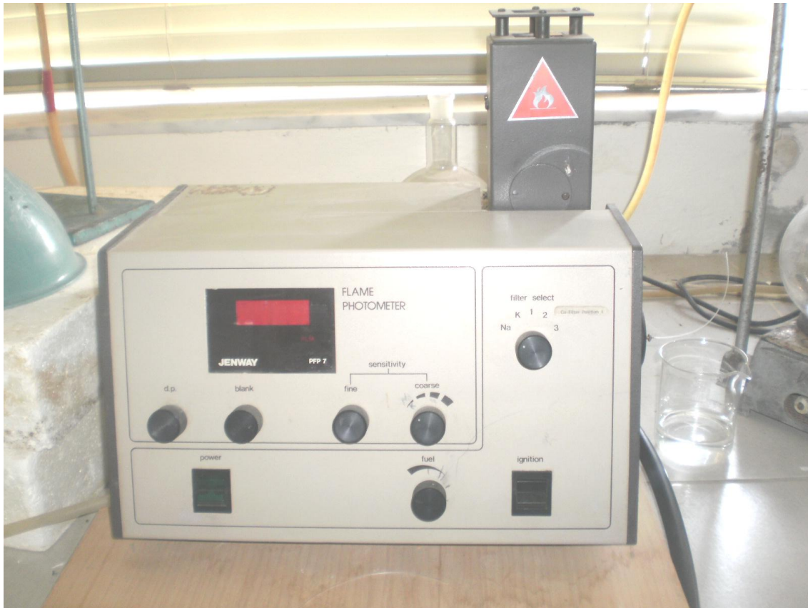
Εικόνα 4.11. Φλογοφωτόμετρο για την στοιχειομετρική ανάλυση Κ.
