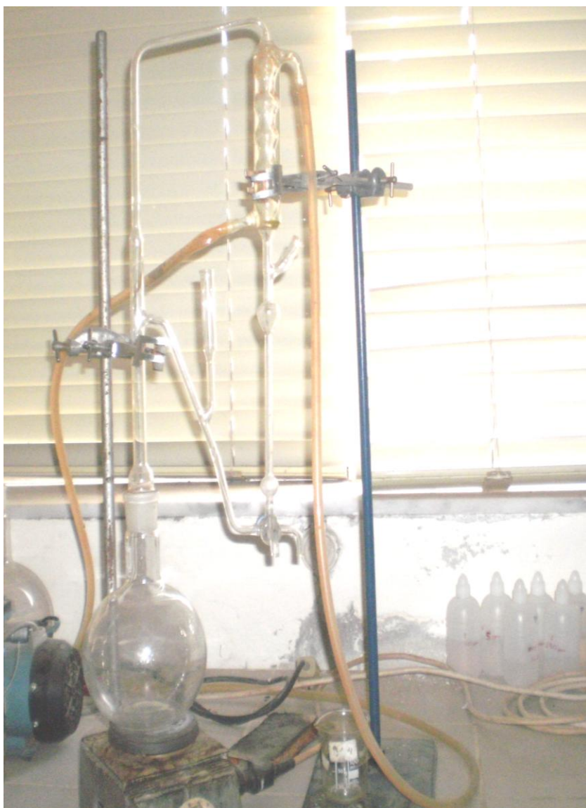
Εικόνα 4.20. Αποστακτική συσκευή τύπου Clevenger.
