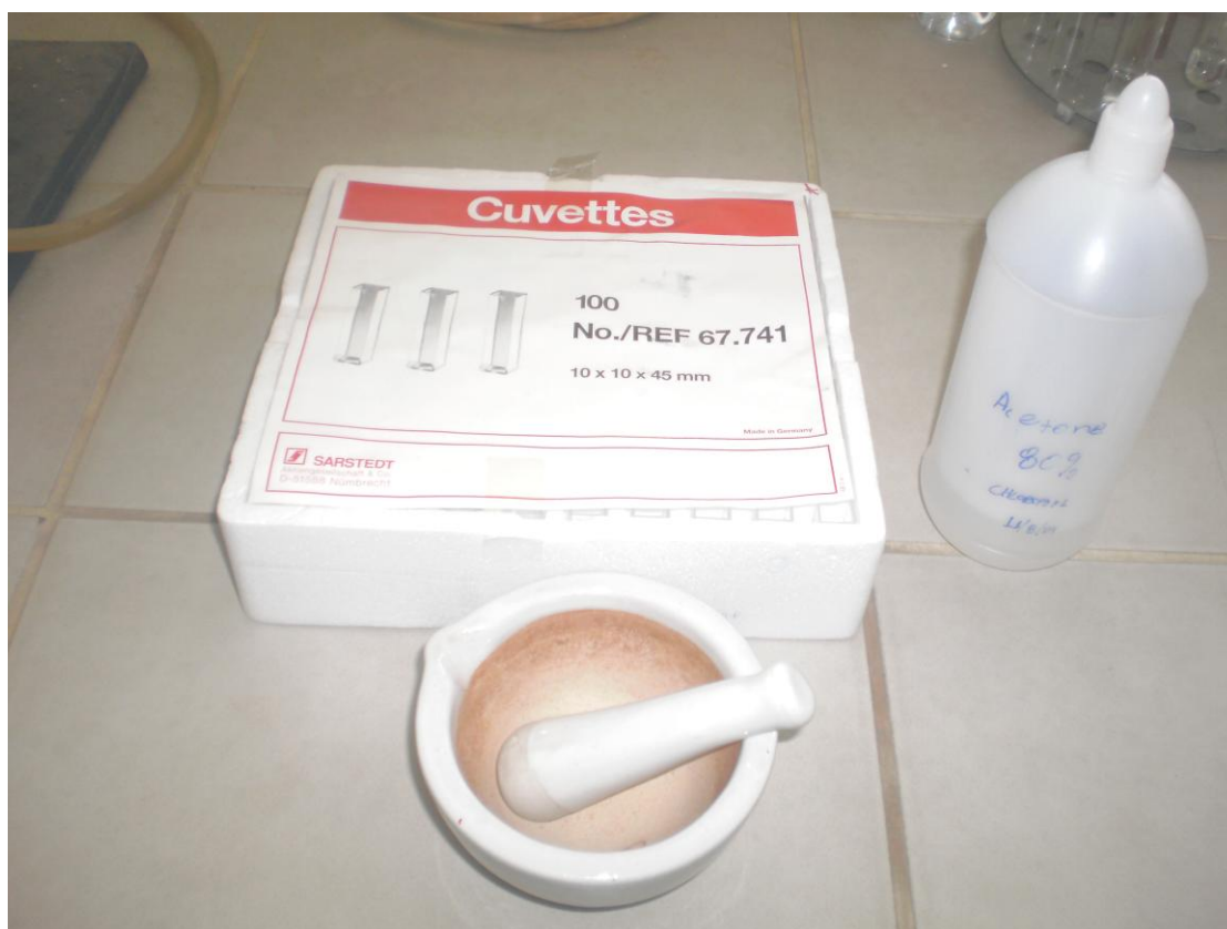
Εικόνα 4.18. Πορσελάνινο γουδί για την λειοτρίβηση των ιστών μαϊντανού για τον προσδιορισμό χλωροφύλλης a, χλωροφύλλης b και ολικών καροτενοειδών.
