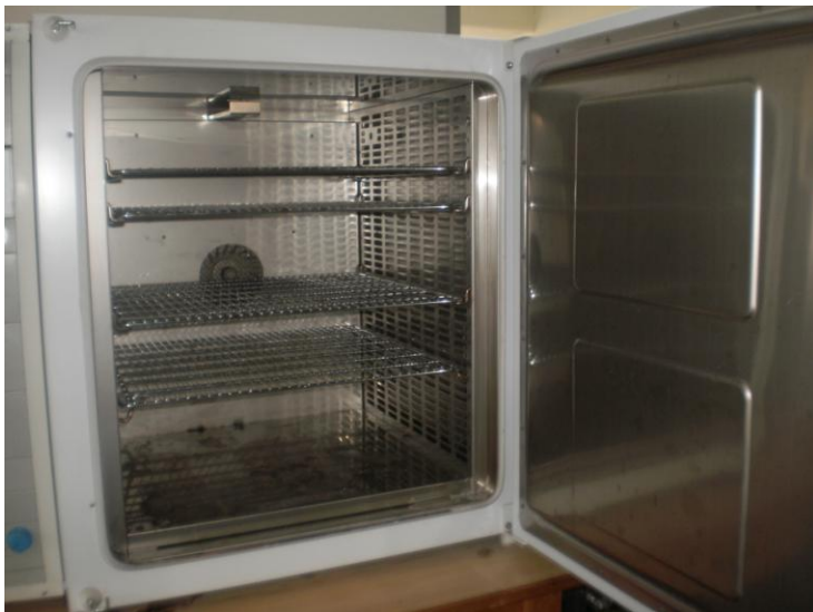
Εικόνα 4.15. Ειδικό πυραντήριο για απομάκρυνση της υγρασίας.
