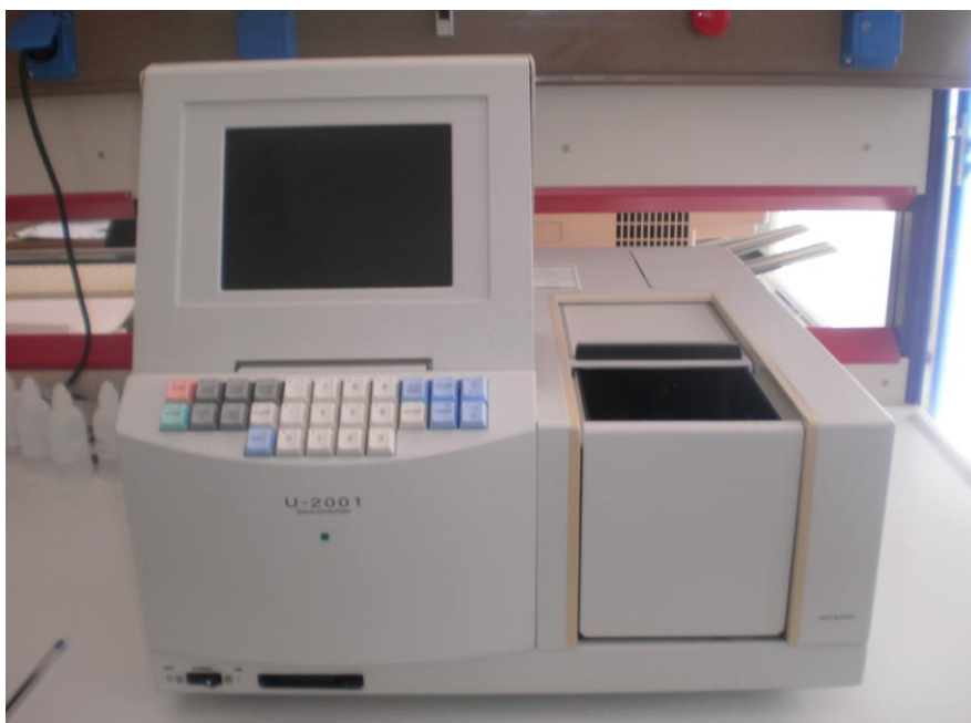
Εικόνα 4.13. Φασματοφωτόμετρο πολλαπλής ανάγνωσης για την στοιχειομετρική ανάλυση \text{NO}_3^- .
