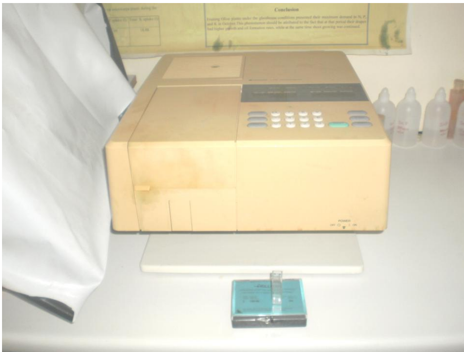
Εικόνα 4.12. Φασματοφωτόμετρο για την στοιχειομετρική ανάλυση του Ρ.
