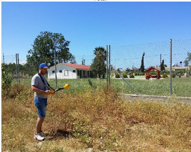
Σχήμα 2.2.11. Διαδικασία (α) και Αποτελέσματα (Safety Evaluation Graph) (β) μέτρησης στη θέση 10 1 ου και 2 ου Νηπιαγωγείου Χρυσοπηγής (Meas. Range: 10,00 V/m. RBW: 5 MHz. Sweep Time: 1,064 s. No. of Runs: 338. Noise Suppr.: Off. AVG: 6 min (99 %).)
