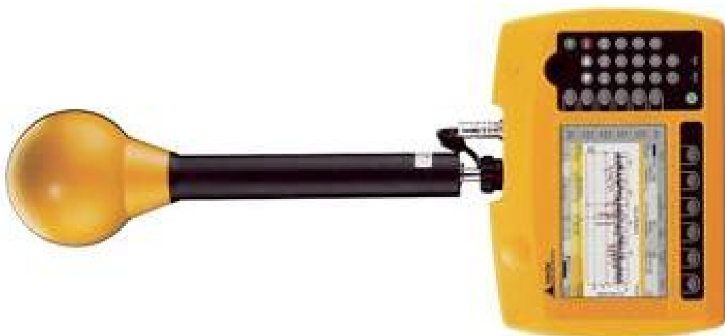
Σχήμα 1. Το πεδίομετρο SRM3006 της εταιρίας NARDA Safety Test Solutions των μετρήσεων μας.
