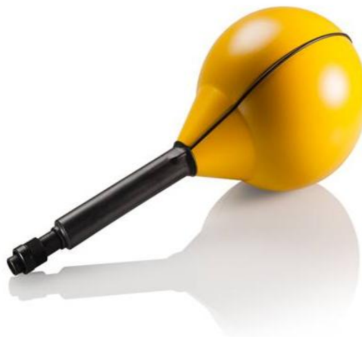
Σχήμα 3. Η κεραία-αισθητήρας (Probe E-Field 3-Axis-Antenna 27MHz – 3 GHz της NARDA Safety Test Solutions) του οργάνου.
