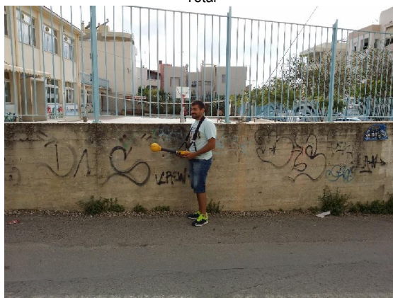
Σχήμα 2.9.4. Διαδικασία (α) και Αποτελέσματα (Safety Evaluation Graph) (β) μέτρησης στη θέση 3,19 ου Δημοτικού και Νηπιαγωγείου (Meas. Range: 9,00 V/m. RBW: 5 MHz. Sweep Time: 1,064 s. No. of Runs: 338. Noise Suppr.: Off. AVG: 6 min (99 %).)
