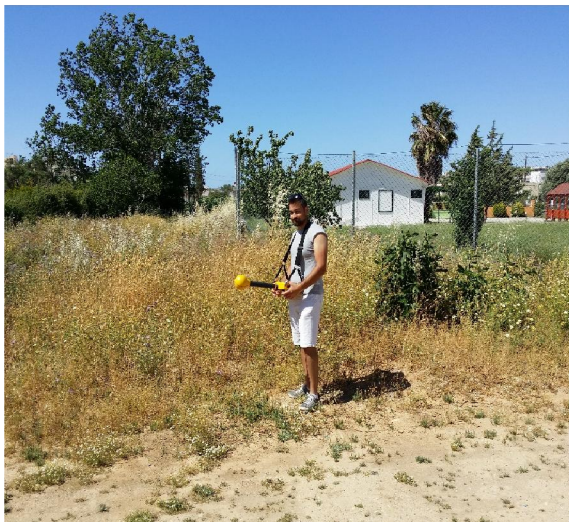
Σχήμα 2.2.13. Διαδικασία (α) και Αποτελέσματα (Safety Evaluation Graph) (β) μέτρησης στη θέση 12 1 ου και 2 ου Νηπιαγωγείου Χρυσοπηγής (Meas. Range: 10,00 V/m. RBW: 5 MHz. Sweep Time: 1,064 s. No. of Runs: 339. Noise Suppr.: Off. AVG: 6 min (99 %).)
