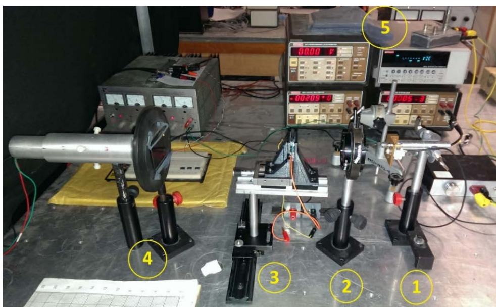
Εικόνα 75: Στήσιμο μετρητικής διαδικασίας, ηλεκτροχρωμικών ιδιοτήτων των διατάξεων στο Πανεπιστήμιο Κρήτης.
