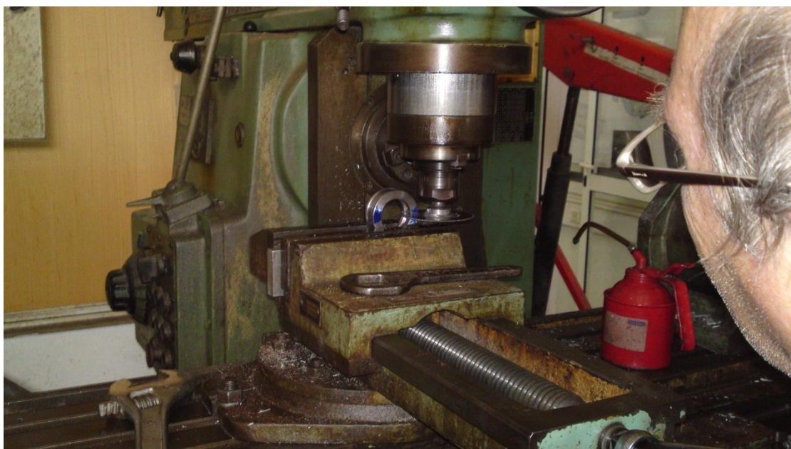
Εικόνα 15 . Λήψη από επιδαπέδιο δράπανο και κατεργασία με δίσκο κοπής.
