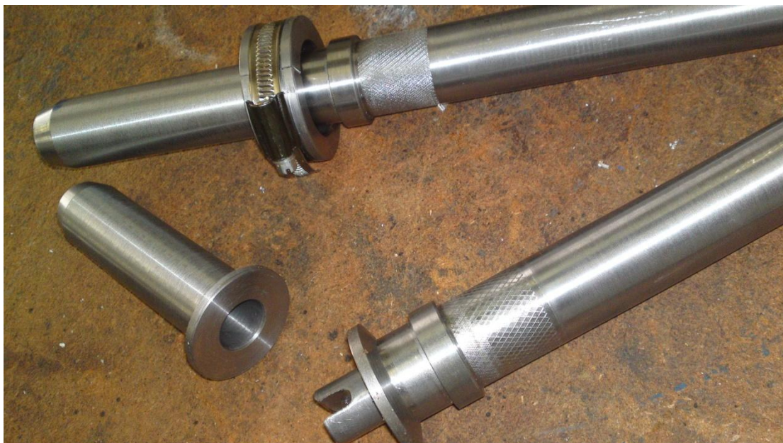
Εικόνα 16 . Αποτέλεσμα από την κατασκευή συνδέσεων των πτερυγίων της ανεμογεννήτριας
