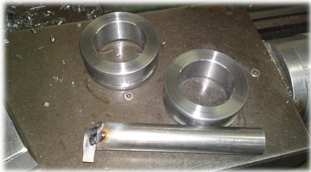
Εικόνα 14 . Αυτοσχέδιο κοπτικό εργαλείο για τις εσωτερικές αυλακώσεις δακτυλίων συνδέσμων πριν την κατασκευή τους.
