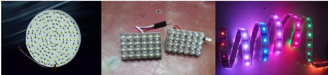
Εικόνα 4.11: Διατάξεις φωτισμού με λαμπτήρες LED.
