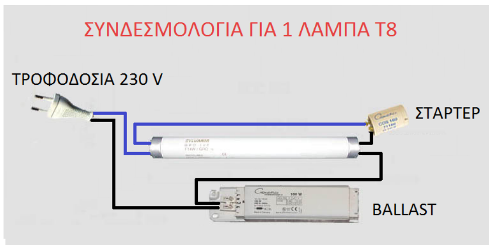
Εικόνα 7.1: Πειραματική διάταξη μαγνητικού μπάλαστ με λαμπτήρα φθορισμού T8.
