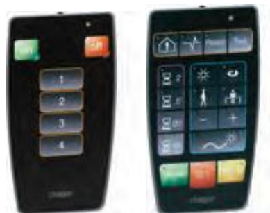
Εικόνα 5.7: Τηλεχειριστήρια προγραμματισμού αισθητήρων παρουσίας.
