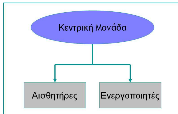
Εικόνα 5.40: Γενική αρχιτεκτονική συστήματος BMS.
