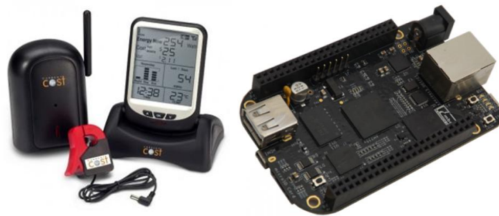
Εικόνα 8.1: Μετρητής ενέργειας και αναπτυσιακό.
