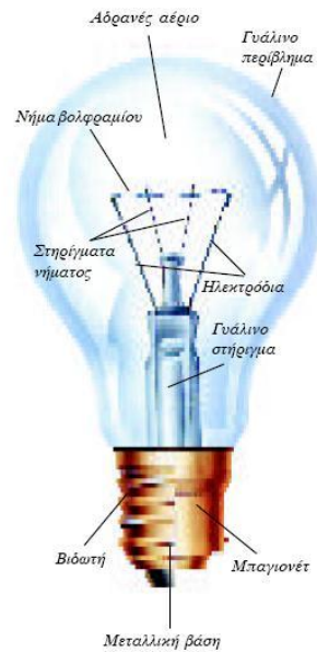
Εικόνα 3.1: Λαμπτήρας πυράκτωσης και τα μέρη που τον αποτελούν.
