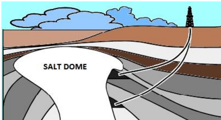
Εικόνα 19: Εκμετάλλευση κοιτασμάτων που βρίσκονται κάτω από δόμο άλατος
