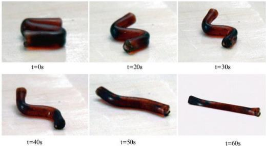
Σχήμα 2.12: Φαινόμενο μνήμης μορφής σε υλικό τύπου τζελ συναρτήσει του χρόνου
