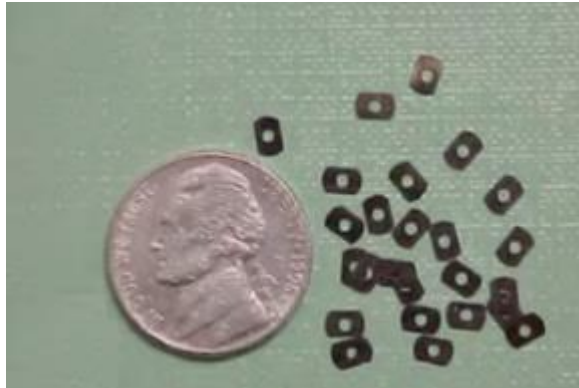
Σχήμα 6.8: Επενεργητής NiTi σε μορφή καμπύμενου δίσκου
