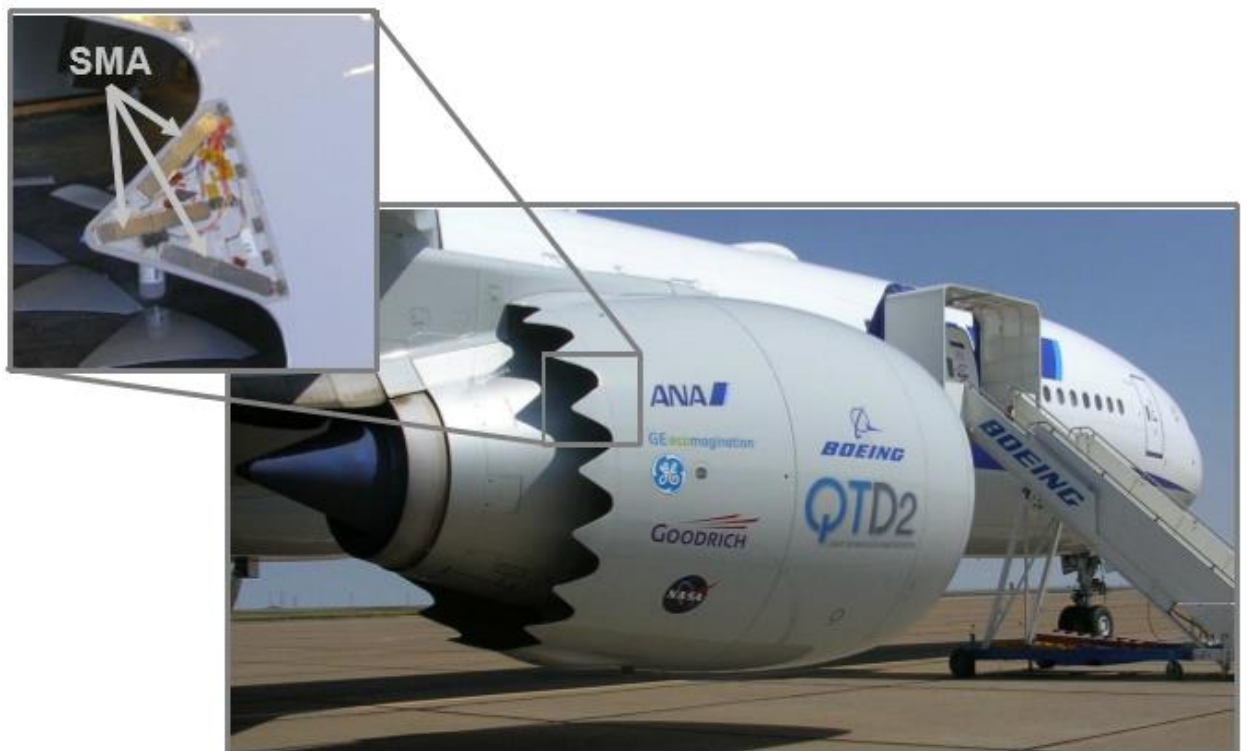
Σχήμα 6.11: Υλικά SMA σε κινητήρα Boeing VGC
