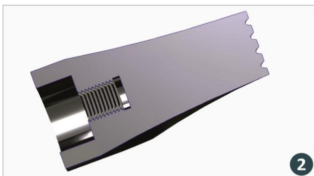
Εικόνα 6.23: Σχεδιασμός οδοντωτής σμίλης, σε μονή όψη (1) και σε όψη με ημιτομή κατά τον άξονα X (2)
