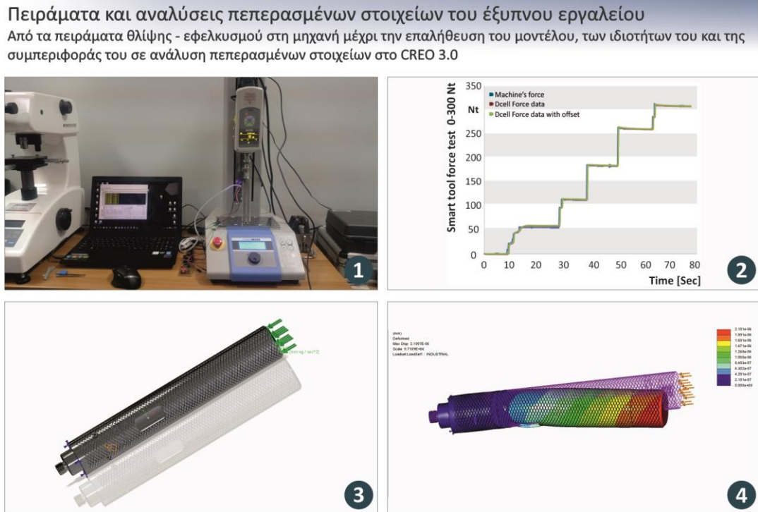
Εικόνα 1.4: Εικόνες από τα πραγματικά πειράματα στη μηχανή εφελκυσμού – θλίψης (1), των αποτελεσμάτων του πειράματος στη μηχανή εφελκυσμού σε προφίλ φόρτισης (2) και από την ανάλυση πεπερασμένων στοιχείων του έξυπνου εργαλείου με το μοντέλο στο λογισμικό προσομοίωσης (3) και των αποτελεσμάτων της ανάλυσης πεπερασμένων στοιχείων (4)
