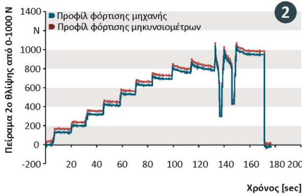
Εικόνα 13.5: Αποτελέσματα θλίψης εργαλείου σε δοκίμιο μαρμάρου Νέστου με τη χρήση της σμίλης σημείου
