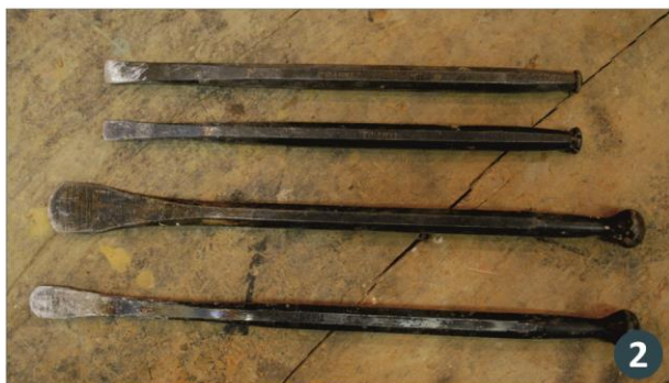
Εικόνα 3.8: Σχέδια κυρτών σμιλών (1) και πραγματικές κυρτών σμιλών χειρός (2) σε διάφορες διαστάσεις
