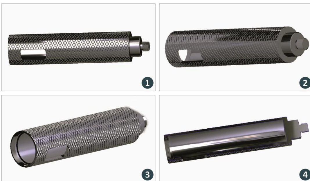
Εικόνα 6.17: Το οπίσθιο τμήμα του έξυπνου εργαλείου κρουστικής λάξευσης, όπως προέκυψε από το στάδιο του επανασχεδιασμού για το βιομηχανοποιημένο πρωτότυπο εργαλείο, σε τρεις όψεις (1), (2), (3) και σε ημιτομή (4).
