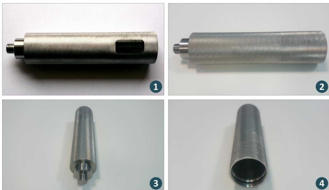
Εικόνα 7.4: Το κατασκευασμένο, κύριο, οπίσθιο μεταλλικό τμήμα του έξυπνου εργαλείου κρουστικής λάξευσης σε τέσσερις όψεις
