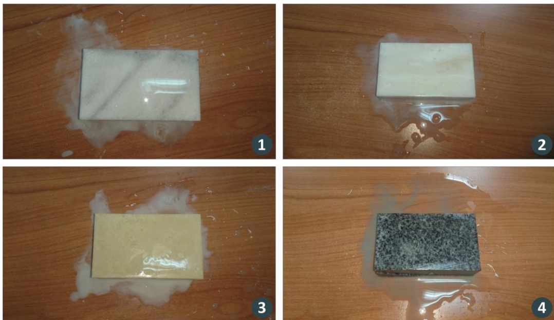
Εικόνα 12.3: Προετοιμασία στίλβωσης επιφανειών λίθινων δοκιμών προς μέτρηση σκληρότητας κατά Vickers. Στίλβωση δοκιμών ποικιλιών μαρμάρου (1), (2), ασβεστόλιθου (3) και γρανίτη (4) με πέντε διαφορετικούς βαθμούς υαλόχαρτου.
