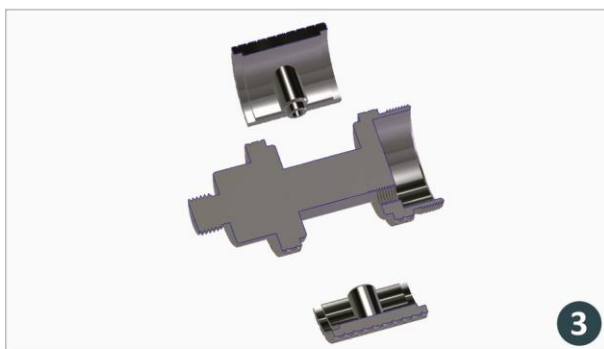
Εικόνα 6.21: Τα τμήματα εφαρμογής των μηκυσιομέτρων, καλύμματα και κύριο τμήμα, σε δύο όψεις (1), (2) και σε όψη με ημιτομή κατά τον άξονα X (3)
