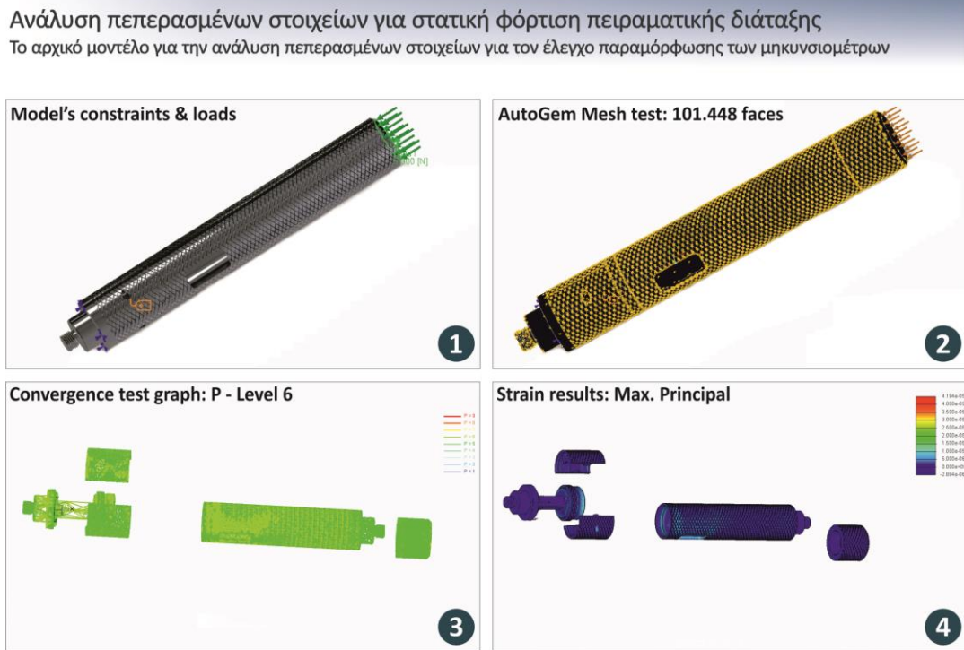
Εικόνα 10.1: Ανάλυση πεπερασμένων στοιχείων, το αρχικό μοντέλο με τη πάκτωση και την εφαρμογή φορτίου (1), το μοντέλο υπό έλεγχο δομής AutoGem (2), το μοντέλο μετά την ανάλυση σε έλεγχο επικάλυψης (convergence) (3) και το μοντέλο σε αποτελέσματα μεγίστων τάσεων (4)
