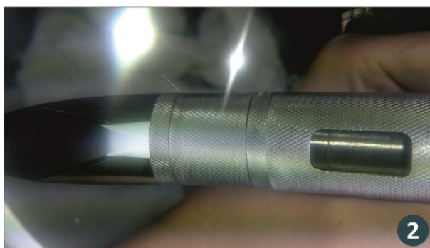
Εικόνα 7.31: Κατεργασία στίλβωσης στην εργαλειομηχανή φρεζαρίσματος αριθμητικού ελέγχου (1) και καθαρισμός των τεμαχίων κάτω από τη μεγεθυντική λάμπα (2)
