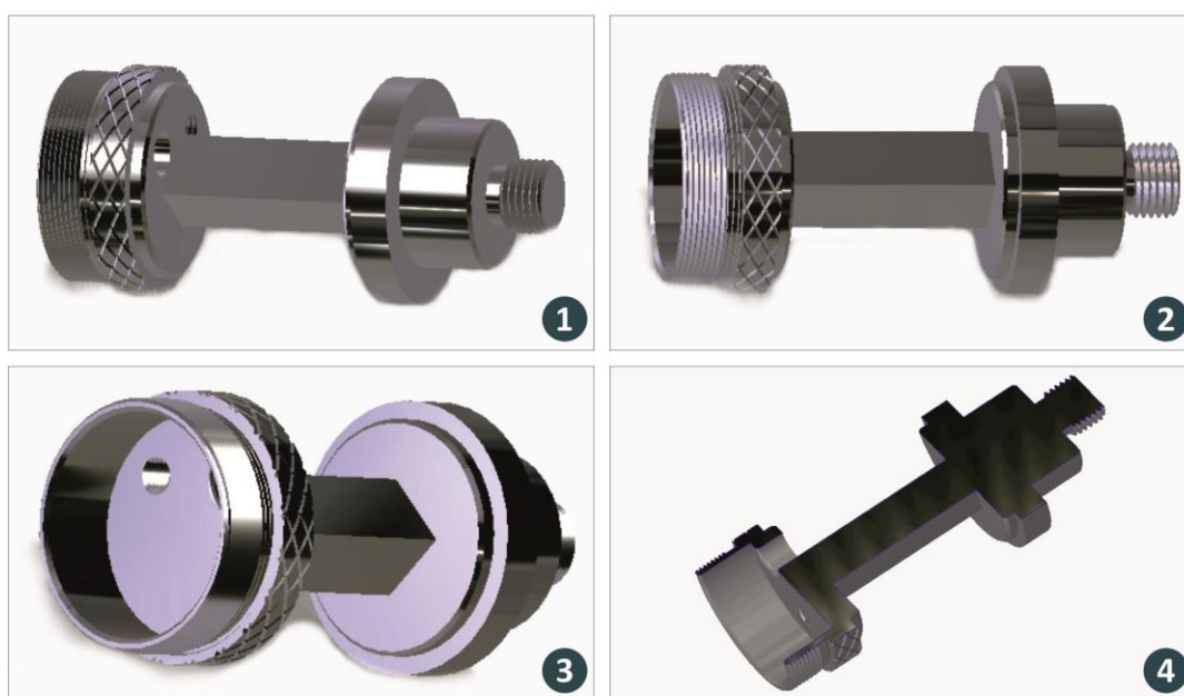
Εικόνα 6.19: Το μοντέλο του τμήματος εφαρμογής των μηκυνσιομέτρων του έξυπνου εργαλείου κρουστικής λάξευσης, βιομηχανοποιημένου πρωτοτύπου, σε τρεις όψεις (1), (2), (3) και σε τομή κατά τον άξονα Υ (4).
