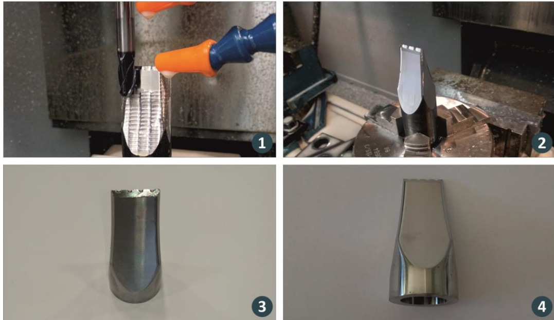
Εικόνα 7.26: Η διαδικασία κατασκευής στην εργαλειομηχανή αριθμητικού ελέγχου (1), (2) και η κατασκευασμένη εναλλάξιμη οδοντωτή σμίλη του έξυπνου εργαλείου κρουστικής λάξευσης σε δυο (2) όψεις (3), (4)
