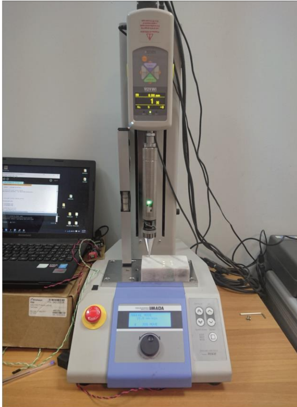
Εικόνα 13.1: Η διάταξη των πειραμάτων θλίψης του εργαλείου, με τη μηχανή θλίψης εφελκυσμού, το έξυπνο εργαλείο και το λίθινο δοκίμιο προς θλίψη
