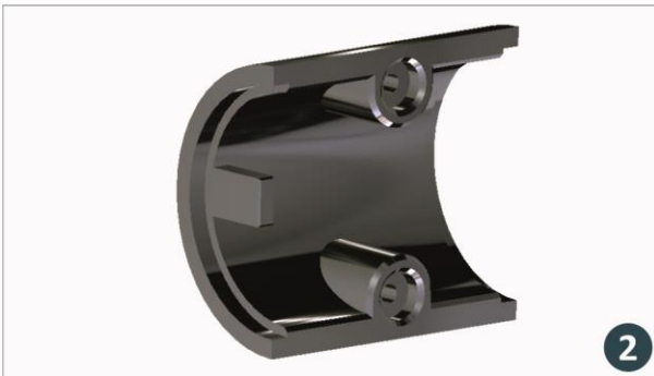
Εικόνα 6.10: Ο αρχικός σχεδιασμός των καλυμμάτων των ηλεκτρονικών μηκυσιομέτρων για το εμπρόσθιο τμήμα εφαρμογής τους
