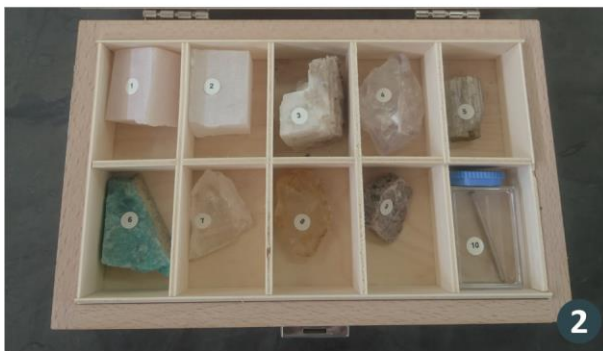
Εικόνα 12.13: Ο μηχανισμός μέτρησης σκληρότητας κατά Mohs και τα εργαλεία μέτρησης στο εργαστήριο (2)
