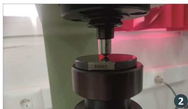
Εικόνα 12.7: Ο μηχανισμός μέτρησης σκληρότητας κατά Rockwell B και C (1) και η μηχανή μέτρησης στο εργαστήριο με δοκίμιο του κατασκευαστή (2)
