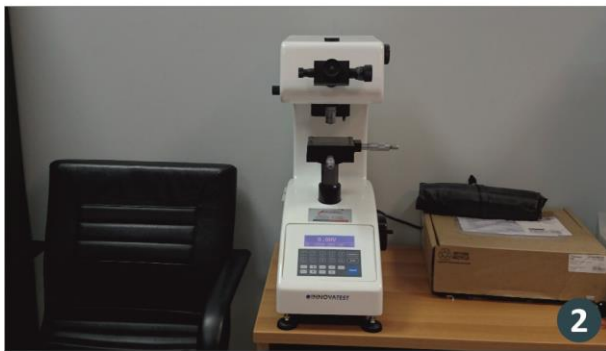
Εικόνα 12.2: Η μέθοδος αποτύπωσης πυραμίδας Vickers (1) και η μηχανή μέτρησης σκληρότητας Vickers στο εργαστήριο (2)
