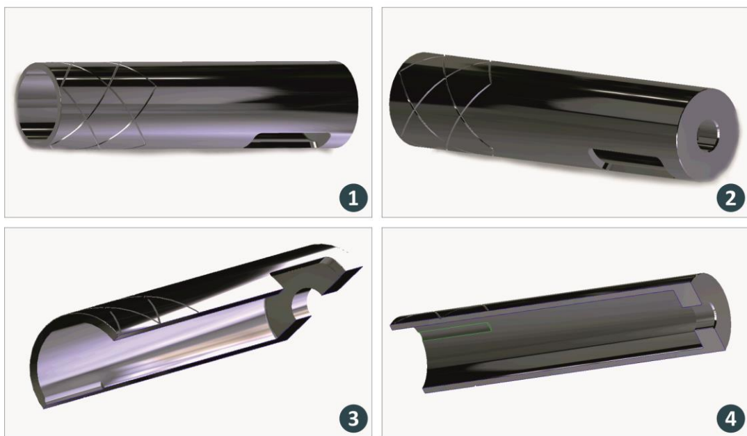
Εικόνα 6.9: Το οπίσθιο τμήμα του έξυπνου εργαλείου κρουστικής λάξευσης, όπως προέκυψε από το στάδιο της βελτίωσης του σχεδιασμού,, σε δύο όψεις (1), (2) και σε δύο όψεις ημιτομής (3), (4).
