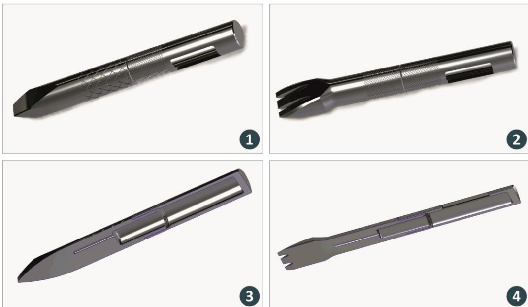
Εικόνα 6.3: Ο αρχικός σχεδιασμός του εργαλείου κρουστικής λάξευσης, σε πλήρη συναρμολόγηση με δύο διαφορετικά εμπρόσθια τμήματα (1), (2) και η συναρμολόγηση του εργαλείου σε ημιτομή και με τα δύο εμπρόσθια τμήματα
