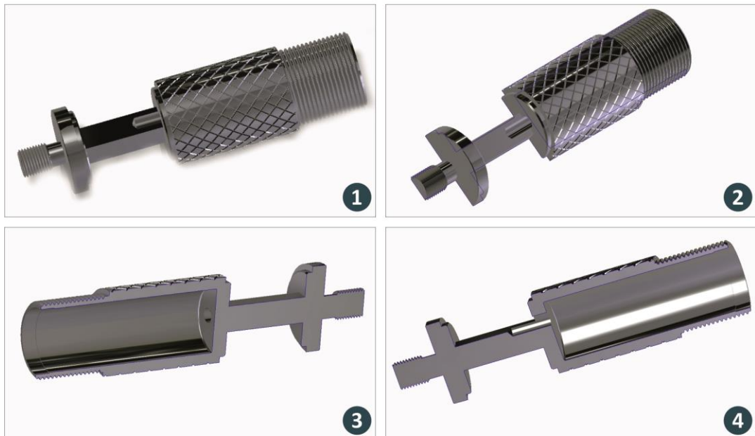
Εικόνα 6.7: Το εμπρόσθιο εναλλάξιμο τμήμα εφαρμογής των μηκυνσιομέτρων όπως προέκυψε από το στάδιο της βελτίωσης του σχεδιασμού, σε δύο όψεις (1), (2) και σε δύο όψεις ημιτομής (3), (4).
