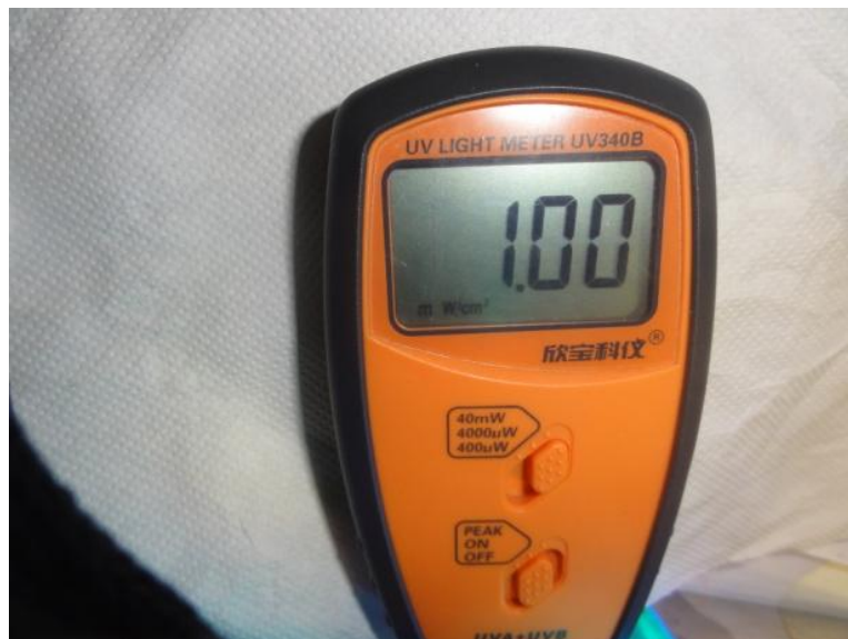
Εικόνα 45: Η ένταση της ακτινοβολίας του λαμπτήρα στο 1\text{mw}/\text{cm}^2=10\text{w}/\text{m}^2
