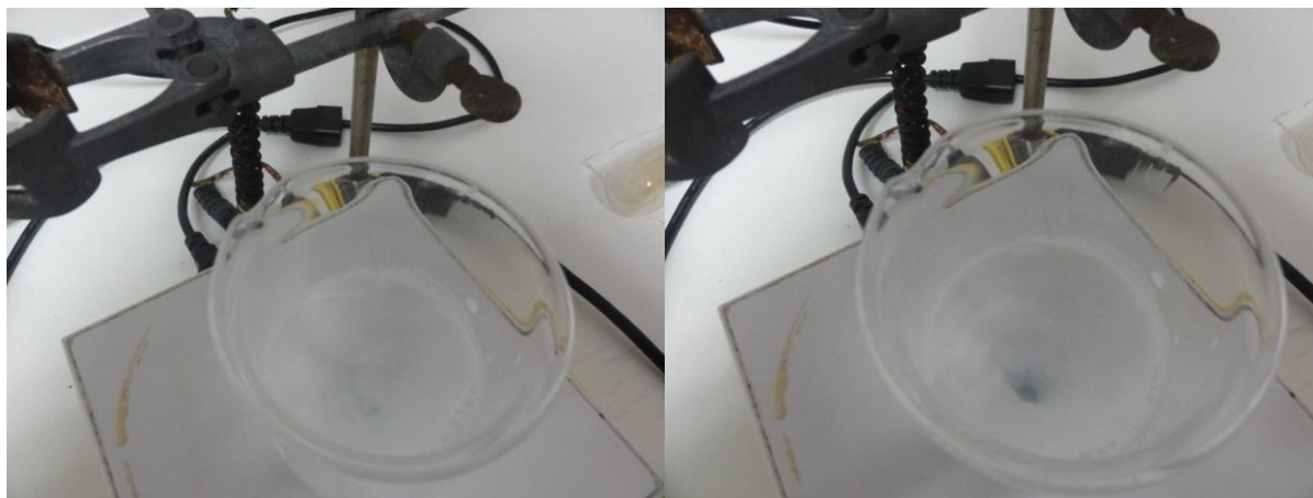
Εικόνα 137: Η μηχανική ανάδευση του μίγματος του νερού με το φωτοκαταλύτη. Αρχικά γίνεται με μικρή ταχύτητα και στη συνέχεια ποιά έντονα.
