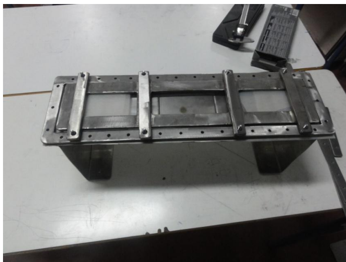
Εικόνα 31: Η διάταξη του φωτοαντιδραστήρα σύμφωνα με την πρώτη προσέγγιση με το μεγάλο οπτικό παράθυρο (340mmX50mm).
