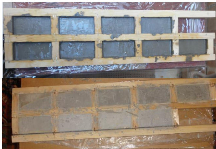
Εικόνα 83: Τα δοκίμια με την πάστα τσιμέντου όταν παρασκευάστηκαν και λίγο πριν την προετοιμασία τους για την πραγματοποίηση της δοκιμής.
