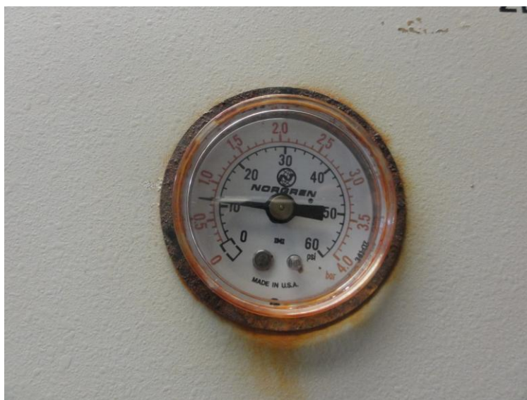
Εικόνα 30: Η πίεση του φέροντος αερίου στον φωτοαντιδραστήρα.
