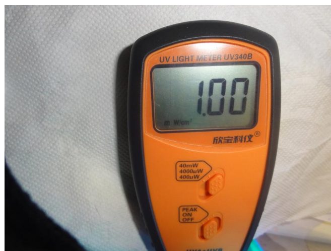
Εικόνα 79: Το όργανο για την μέτρηση της έντασης της ακτινοβολίας στην επιφάνεια του φωτοκαταλύτη. 1w/cm 2 =10w/m 2
