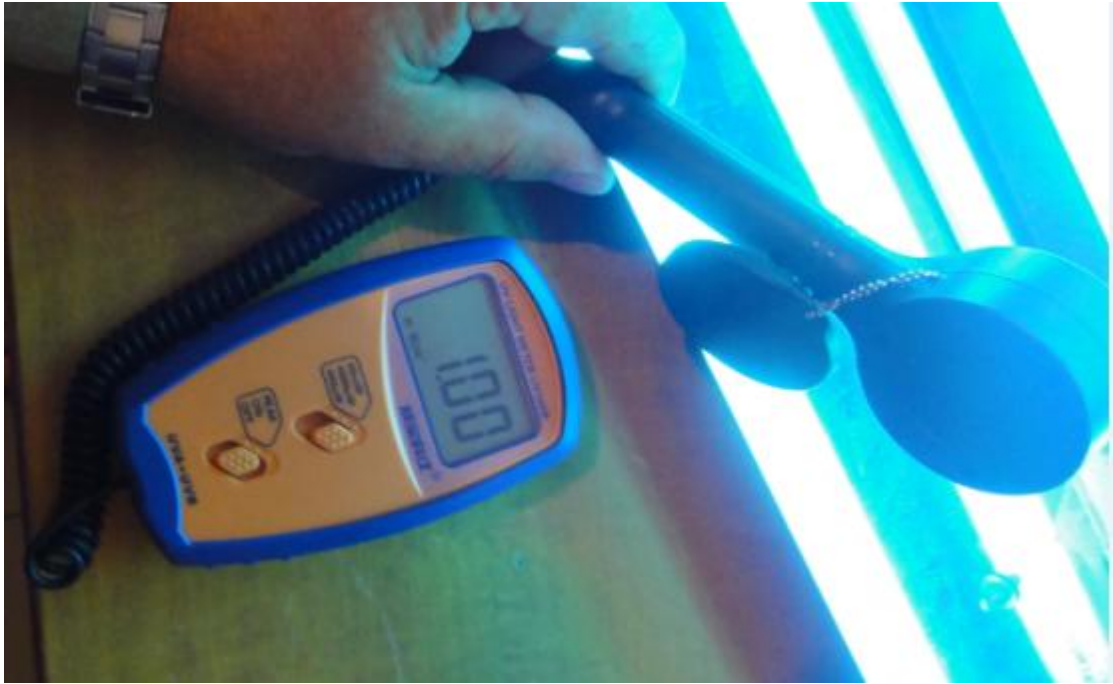
Εικόνα 121: Το φορητό φωτο-φασματόμετρο UV Light meter UV 340B με το οποίο μετρήθηκε η ακτινοβολία των λαμπτήρων στην περιοχή UV-A 300-400nm.
