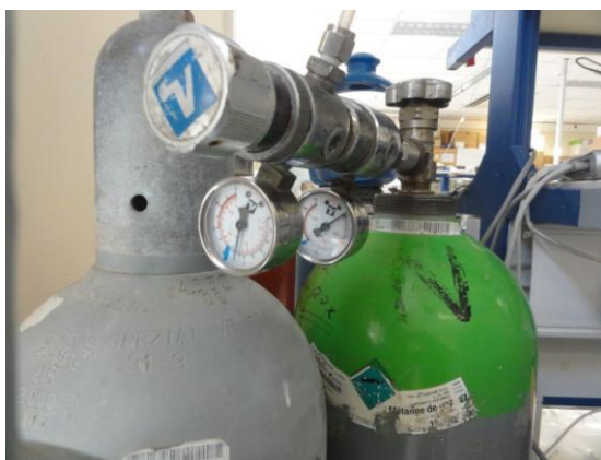
Εικόνα 61: Η φιάλη με το NO συνδεδεμένη με τον μανοεκτονωτή της ρυθμισμένο στα 5bar.
