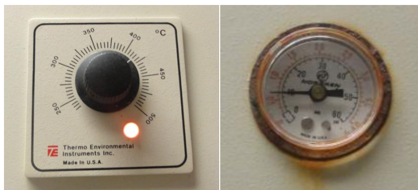
Εικόνα 76: Η ρύθμιση της θερμοκρασίας στον θάλαμο της συσκευής Thermo Model 111 στους 415°C αριστερά και της πίεσης του αέρα στα 10psi δεξιά.
