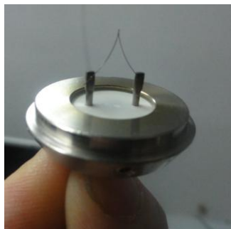
Εικόνα 51: Το νήμα που αποτελεί την πηγή των ηλεκτρονίων του μικροσκοπίου.
