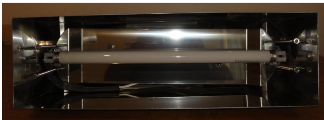
Εικόνα 50: Ο λαμπτήρας Sylvania Black light 368 F15W/T8/BL368 στερεωμένος στο εσωτερικό μέρος του καπακιού του φωτοαντιδραστήρα.
