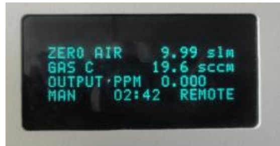
Εικόνα 77: Οι ρυθμίσεις της συσκευής "Model 146C Dynamic Gas Calibrator" οι τιμές των παροχών
