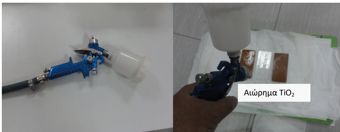
Εικόνα 138: Ο αερογράφος αριστερά και δεξιά τη στιγμή που ψεκάζεται αιώρημα φωτοκαταλύτη στα πλακίδια.
