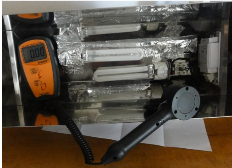
Εικόνα 44: Το καπάκι του φωτοαντιδραστήρα με τη βάση πάνω στην οποία στηρίζονται οι δύο λάμπες 2U των 9W.
