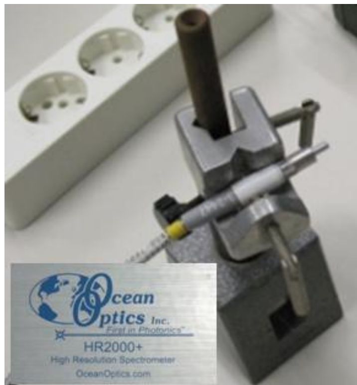
Εικόνα 119: Το αισθητήριο του Ocean Optics High Resolution Spectrometer HR-2000+
