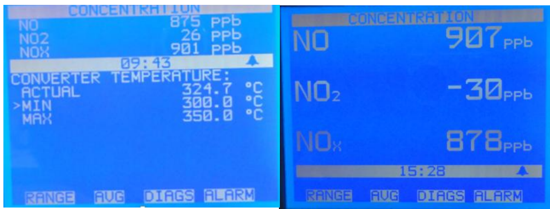
Εικόνα 80: Αριστερά η οθόνη της συσκευής φωτοαύγειας μόλις ολοκληρώθηκε η προθέρμανση της και δεξιά η συγκέντρωση του ρύπου NO της τάξης μεγέθους 900ppb.
