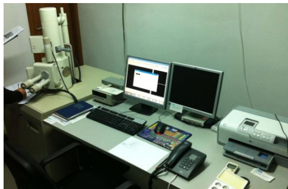
Εικόνα 54: Η διάταξη του ηλεκτρονικού μικροσκοπίου S.E.M στο εργαστήριο.
