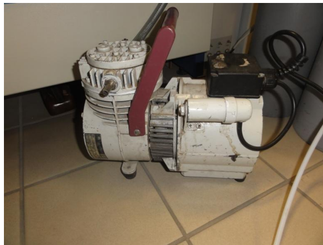
Εικόνα 66: Ο συμπιεστής ο οποίος αναρροφά τον αέρα του εργαστηρίου για να καθαριστεί.
