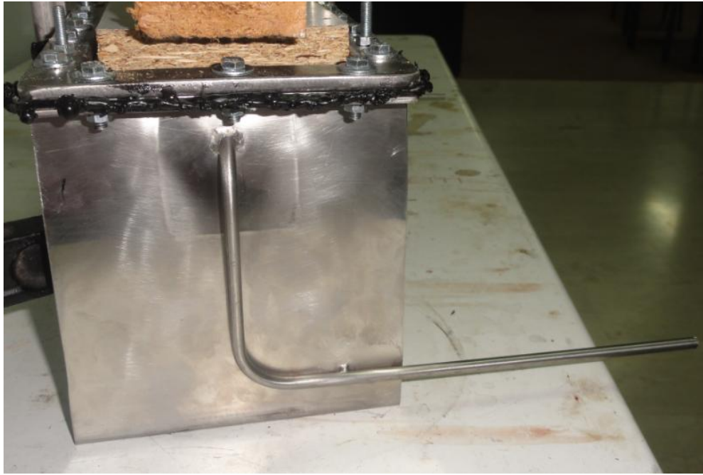
Εικόνα 34: Οι συνδέσεις εισόδου και εξόδου του φέροντος αερίου στον φωτοαντιδραστήρα.
