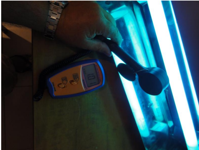
Εικόνα 46: "Η ένταση της ακτινοβολίας του λαμπτήρα στο 1,01\text{mw}/\text{cm}^2=10,1\text{w}/\text{m}^2
