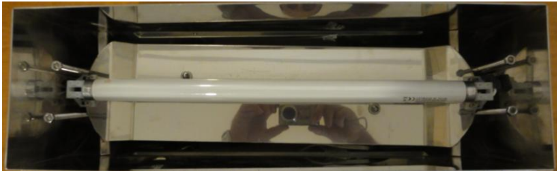
Εικόνα 43: Το καπάκι του φωτοαντιδραστήρα στο οποίο έχει στερεωθεί η λάμπα της Sylvania.
