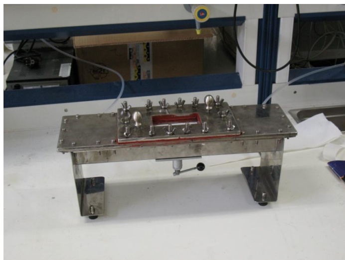
Εικόνα 32: Η διάταξη του φωτοαντιδραστήρα σύμφωνα με την δεύτερη προσέγγιση με το μικρό οπτικό παράθυρο(102mmX52mm).
