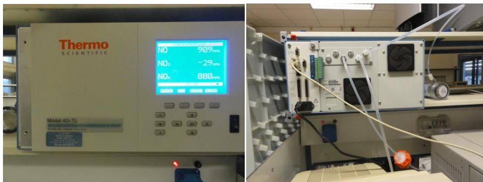
Εικόνα 73: Η πρόσοψη και το πίσω μέρος της συσκευής της χημειοφωταύγειας.
