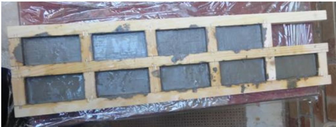
Εικόνα 136: Το καλούπι άδειο και στη συνέχεια με τα δοκίμια από πάστα τσιμέντου.
