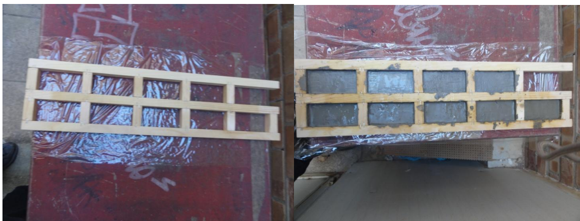
Εικόνα 58: Αριστερά το ξύλινο καλούπι και δεξιά έχοντας τοποθετηθεί το μίγμα για κάθε ένα δοκίμιο στο εσωτερικό του.
