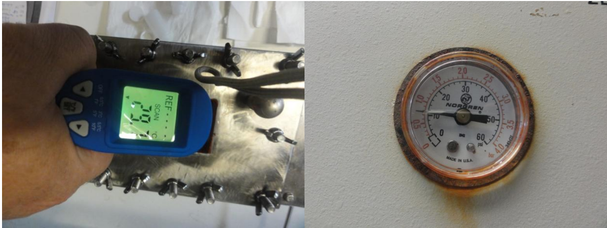
Εικόνα 94: Η θερμοκρασία του δοκιμίου μετά το τέλος της δοκιμής στους 30°C και η πίεση του φέροντος αερίου στα 10psi.
