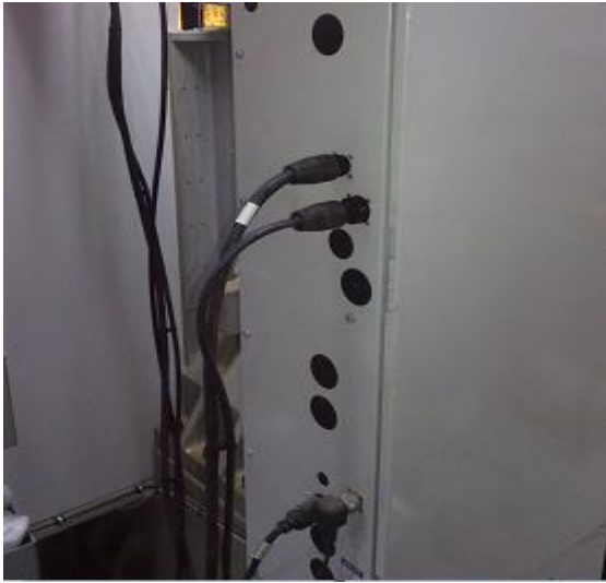
Εικόνα 3.4.2.2 Απεικόνιση υποδοχών (θυρών) για τη σύνδεση του 4ου άξονα στο πίσω μέρος της CNC
