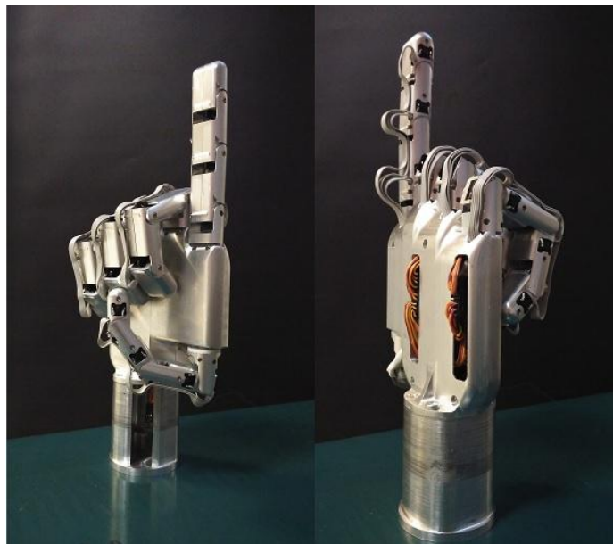
Εικόνα 2.1 το μεταλλικό ρομποτικό χέρι TALOS II
