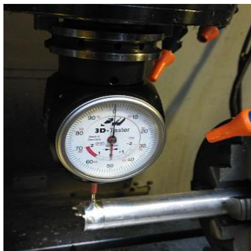
Εικόνα 3.4.2.7 Μηδενισμός κέντρου του ακατέργαστου στον άξονα z
