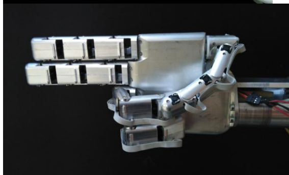
Εικόνα 1.4.7 Το ρομποτικό χέρι TALOS I το οποίο κατασκευάστηκε στο ΤΕΙ Κρήτης[18]
