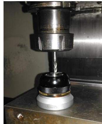
Εικόνα 3.4.2 Απεικόνιση επαφής της κορυφής του κοπτικού στο εξάρτημα αντιστάθμισης.
