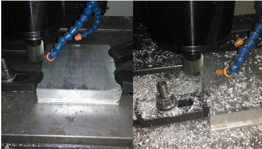
Εικόνα 3.5.2.1 Απεικόνιση δημιουργίας 4ον εγκοπών στήριξης ακατέργαστου
