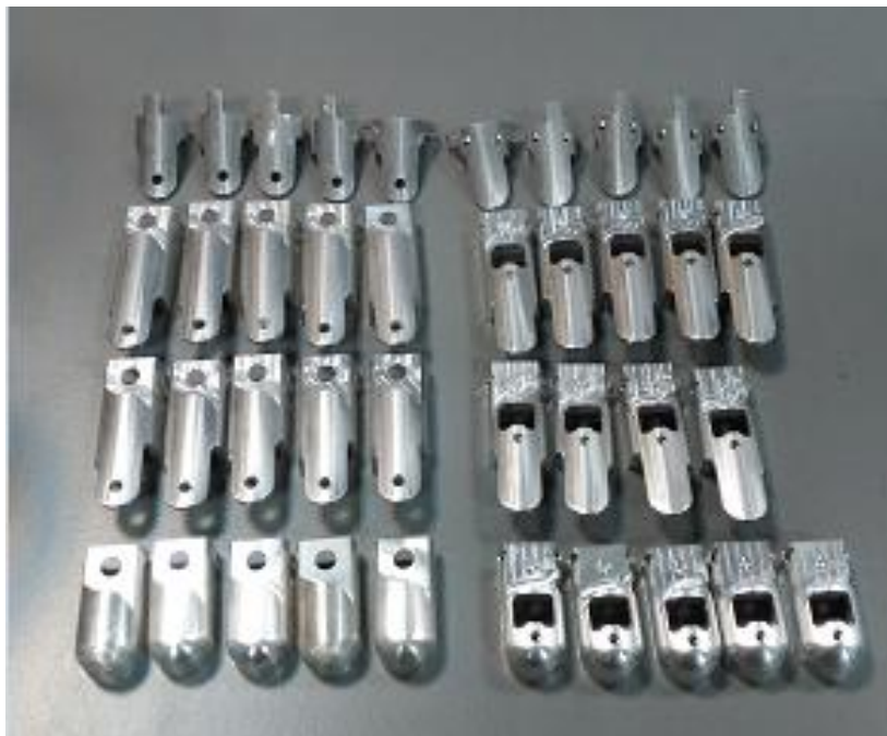
Εικόνα 4.1.1 Απεικόνιση κομματιών των δακτύλων μετά από επεξεργασία (λείανση & επεξεργασία εγχοπών)
