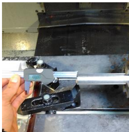
Εικόνα 3.3.1.1 Απεικόνιση σημείου μηδέν στον (x) του ακατέργαστου από το τσοκ του 4 ου άξονα με τη χρήση παχυμέτρου
