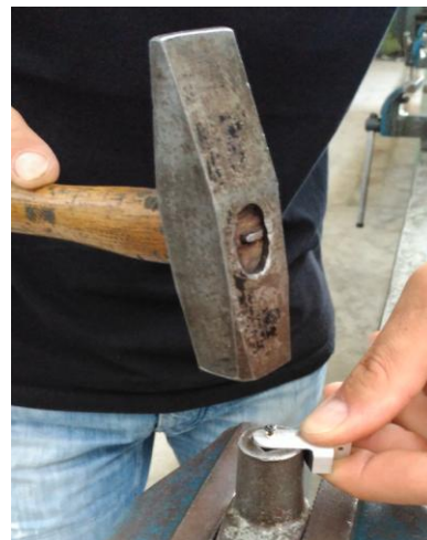
Εικόνα 4.1.2.2β Χτύπημα με την χρήση ενός σφυριού για αποσυμπίεση του γραναζιού
