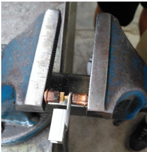
Εικόνα 4.1.2.1α Απεικόνιση τρόπου τοποθέτησης του γραναζιού και των κυλίνδρων πάνω στην μέγγενη
