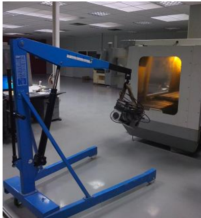
Εικόνα 3.4.2.1 Απεικόνιση εισόδου του 4ου άξονα στο εσωτερικό της CNC
