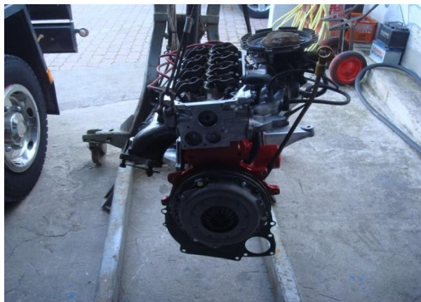
εικ.7 τοποθέτηση δίσκο πλατό1
