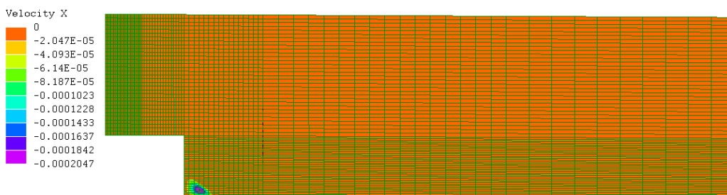
Γραφικό αποτέλεσμα για εξομοίωση ροής σε αορτή με ανεύρυσμα 50% με αποτύπωση του μεγέθους “Velocity X” και περιορισμένο εύρος τιμών αποτύπωσης
