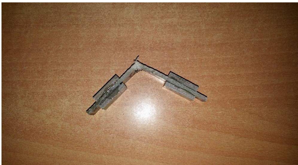
Σχήμα 6.9: Ενδεικτική φωτογραφία δοκιμίου μετά τον καταστροφικό έλεγχο θλίψης
