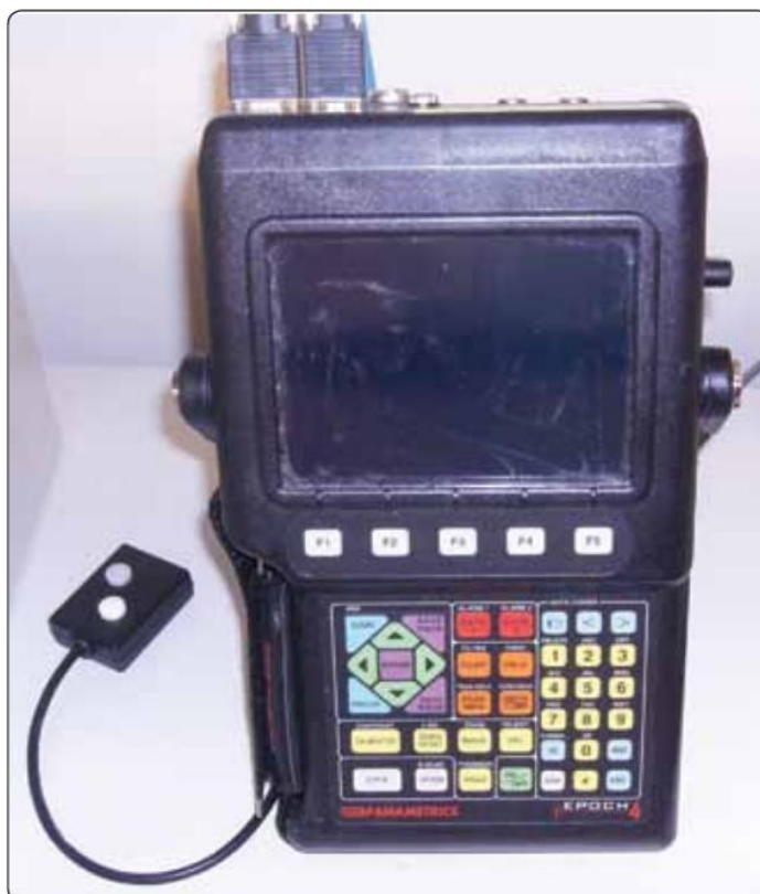
Σχήμα 2.8: Μέθοδος παλμικών Υπερήχων
