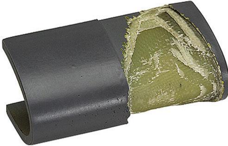
Σχήμα 2.9: Ορατές φθορές σε σύνθετο υλικό.
