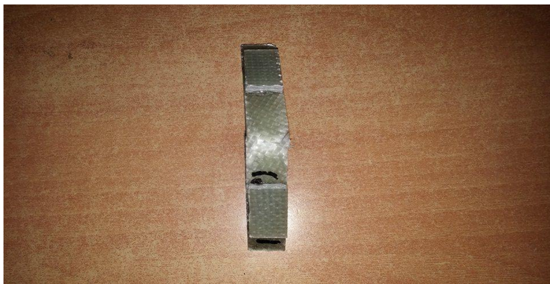
Σχήμα 6.10: Ενδεικτική φωτογραφία δοκιμίου μετά τον καταστροφικό έλεγχο θλίψης
