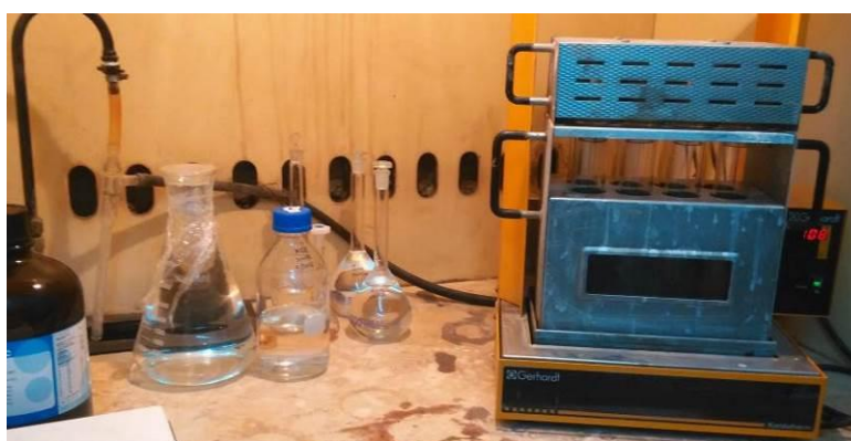
Εικόνα 17. Μηχάνημα της πέψης Kjeldahl Digestion Instrument
