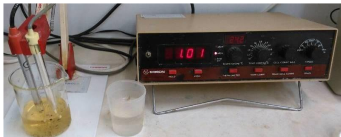
Εικόνα 23. Μέτρηση της E.C. στο υγρό απορροής
