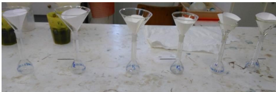
Εικόνα 18. Ογκομετρικές φιάλες των 50ml ένα μικρό χωνί και πάνω τους ένα φίλτρο Whatman N 0 4 στις έξι επεμβάσεις
