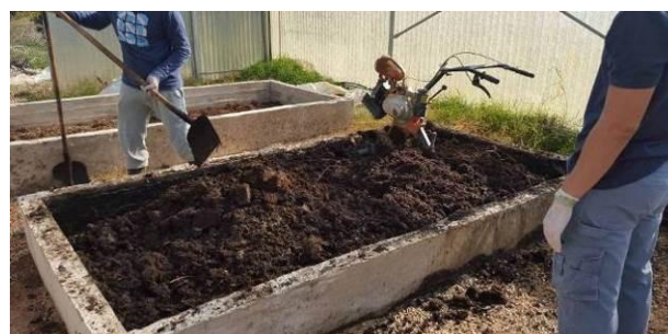
Εικόνα 10: Ανάδευση υλικού κατά την ηλιακή ξήρανση
