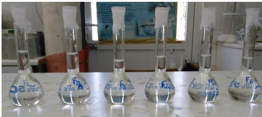
Εικόνα 19. Ογκομετρικές φιάλες των 50ml, 10ml από το stock διάλυμα και 10ml από το αντιδραστήριο του βαναδομολυβδαινικού αμμωνίου στις έξι επεμβάσεις
