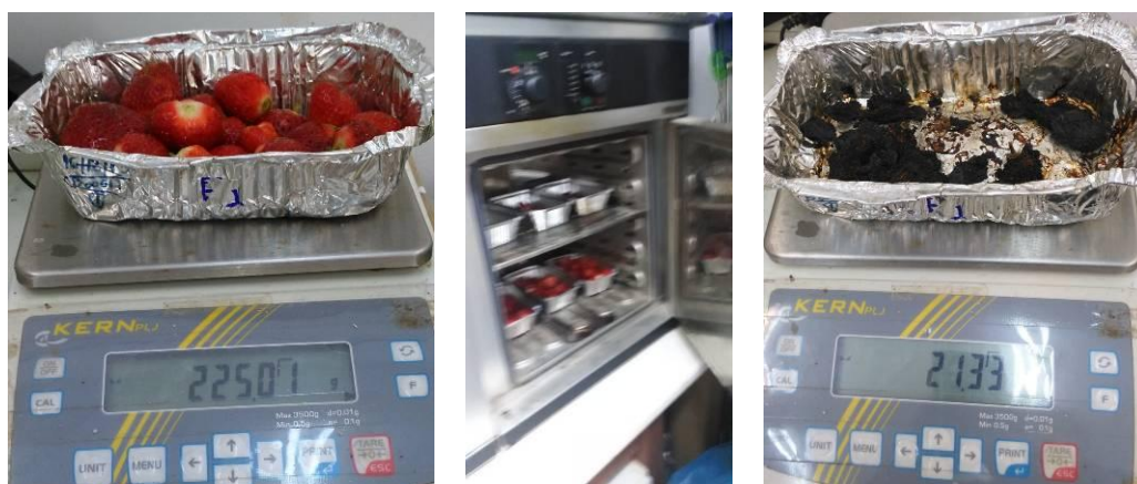
Εικόνα 29. Αριστερά μέτρηση νωπού βάρους καρπών, στο κέντρο τοποθέτηση τους σε φούρνο ξήρανσης και δεξιά μέτρηση του ξηρού βάρους των καρπών
