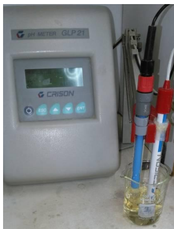
Εικόνα 22. Μέτρηση του pH στο υγρό απορροής
