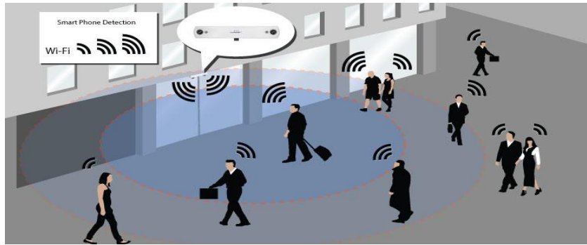
Σχήμα 4. Αρχή λειτουργίας της τεχνολογίας καταμέτρησης επισκεπτών μέσω ίχνους WiFi.
