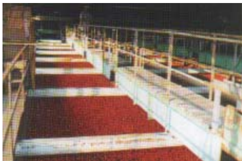
Εικ.13.10 Δεξαμενές αποθήκευσης παραλαβόμενης τομάτας
