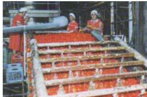
Εικ.13.11 Τελικό πλύσιμο και προώθηση της τομάτας στην ταινία διαλογής
