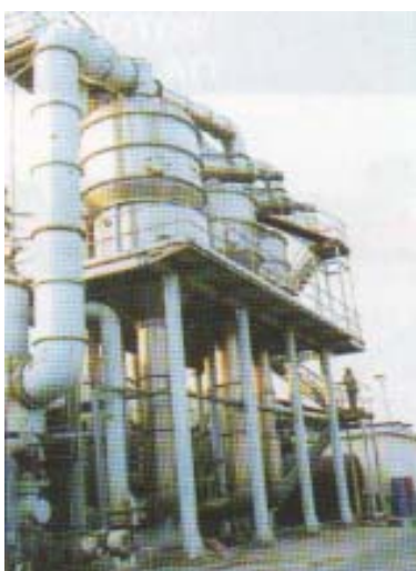
Εικ.13.16 Συγκρότημα συμπυκνωτού χυμού τομάτας συνεχούς ροής.
