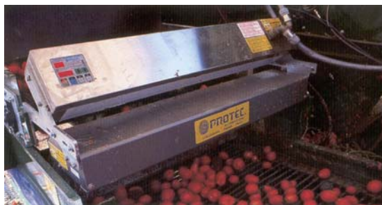
Εικ.13.7 Φωτοκύτταρα χρωματικής διαλογής τομάτας
