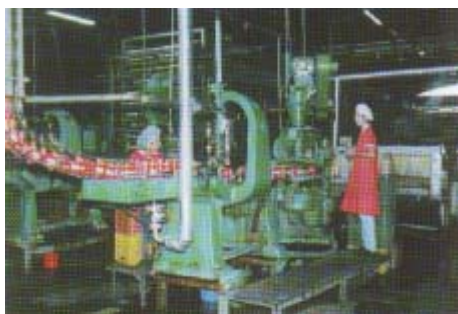
Εικ.13.18 Συγκρότημα γεμιστικού-κλειστικού κυττίων τοματοπολτού.
