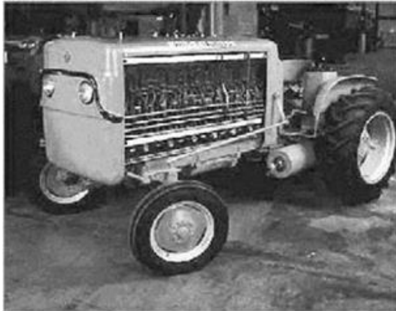
Σχήμα 3.5 Το πρώτο όχημα που χρησιμοποιεί κυψέλη καυσίμου, με ικανότητα ιπποδύναμης 20 hp (15kW) του Harry Karl Ihrig
