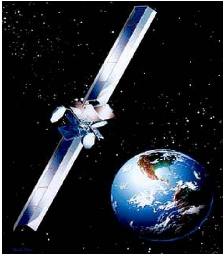
Σχήμα 1.18 Δορυφόρος Anik-F1 της Boeing που χρησιμοποιεί φωτοβολταικά για την κάλυψη ηλεκτρικής ενέργειας
