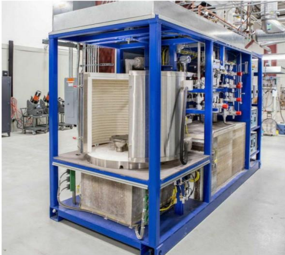
Σχήμα 3.19 Κυψέλη καυσίμου στερεού οξειδίου (SOFC)
