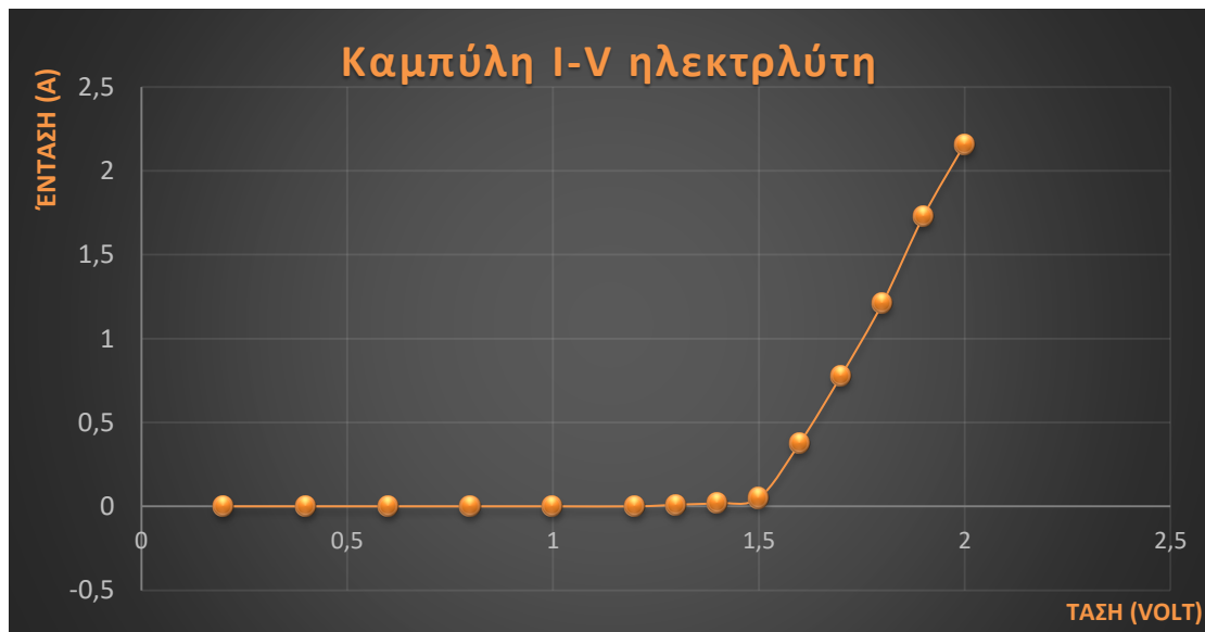
Σχήμα 2.2 Καμπύλη (I-V) ενός ηλεκτρολύτη τύπου PEM
