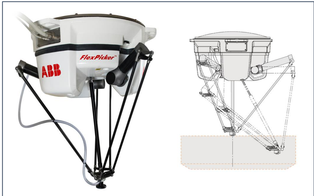
Εικόνα 2.14: Μηχανισμός τεσσάρων βαθμών ελευθερίας τύπου Delta robot από την ABB.
