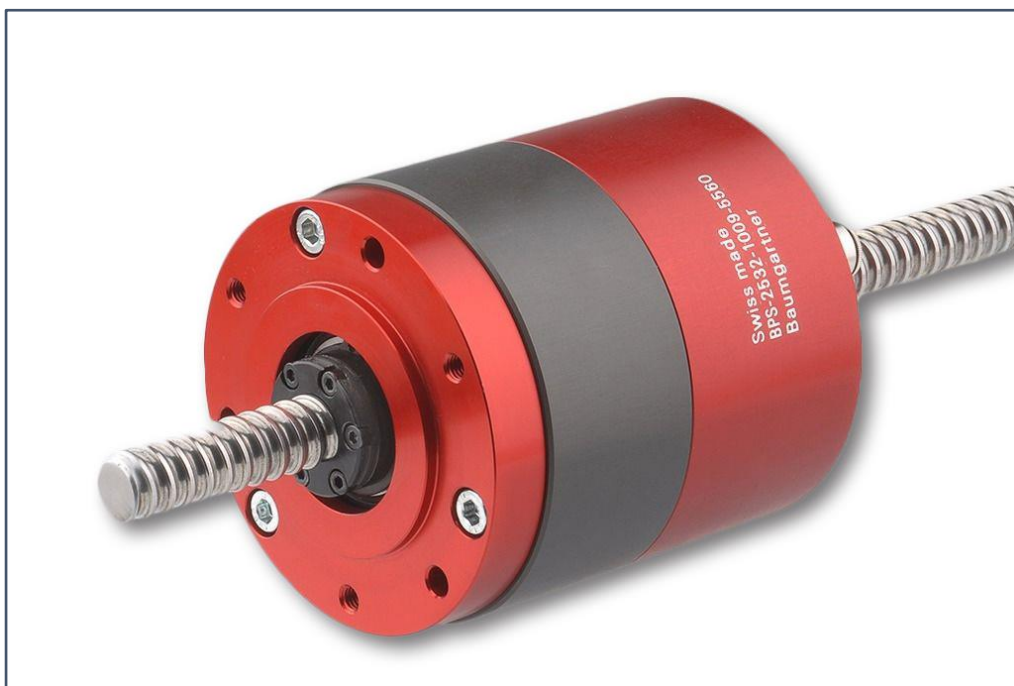
Εικόνα 2.4: Κινητήρας τύπου Stepper που ενσωματώνει επανακυκλοφορούντα σφαιρίδια με δυνατότητα ροπής από 1,7 έως 10 Nm.
