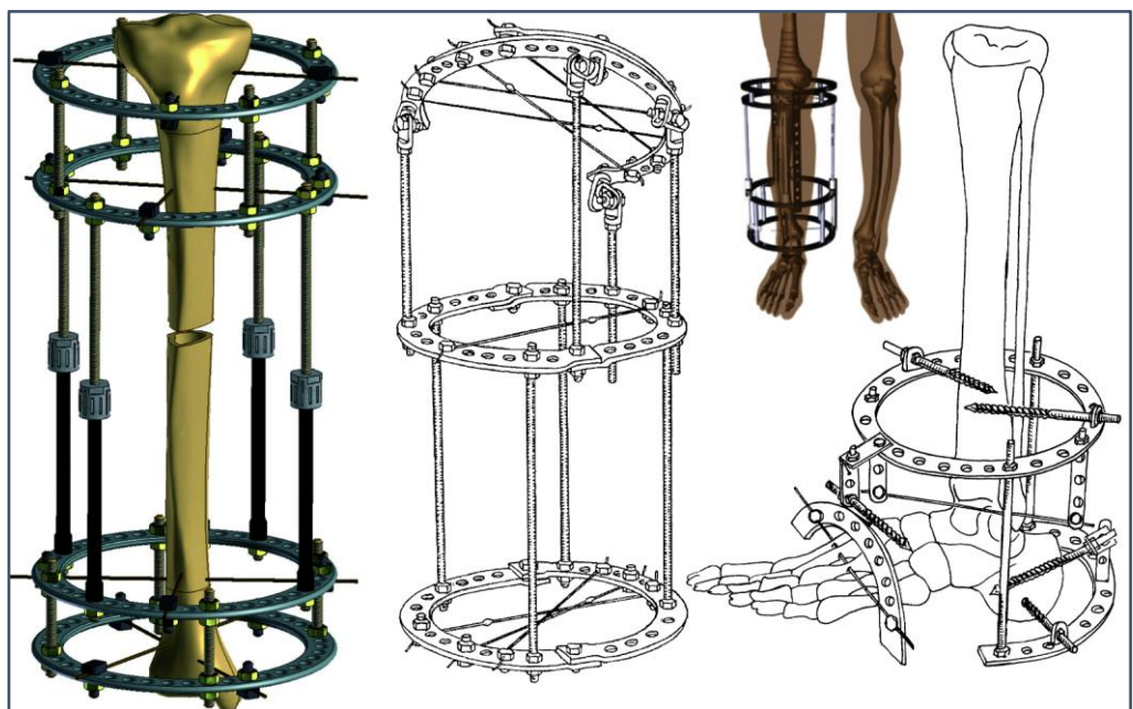
Εικόνα 3.12: Σχηματική αναπαράσταση συσκευών οστεογένεσης με τη χρήση πλατφόρμας Stewart.
