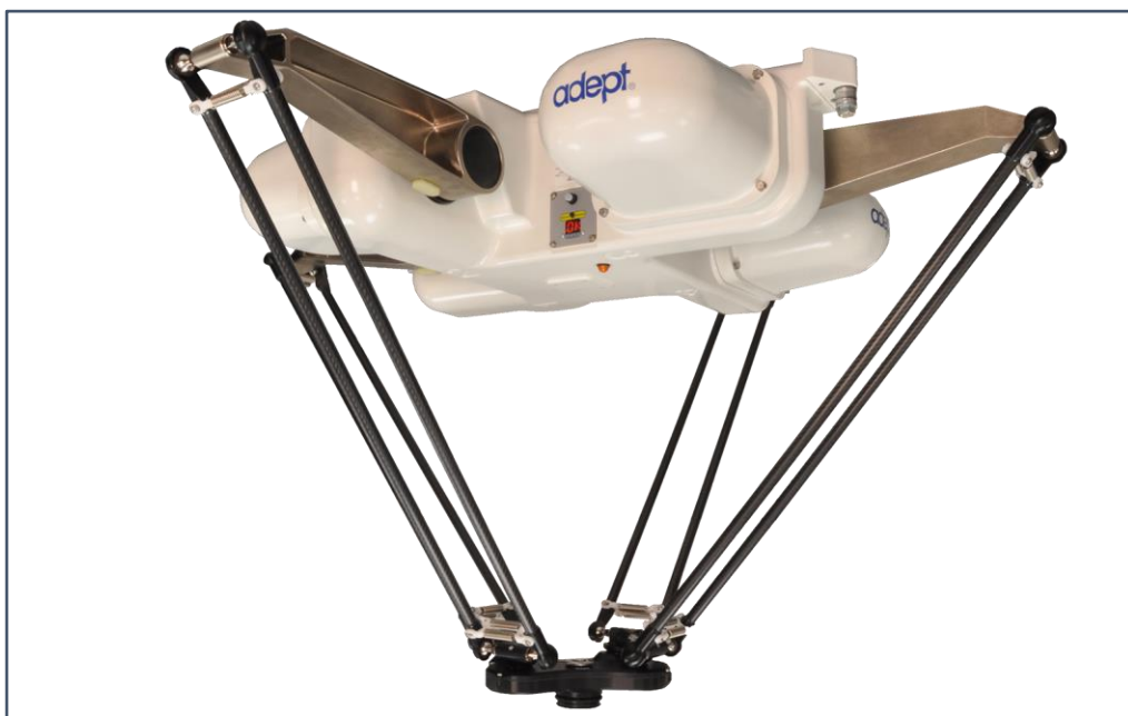
Εικόνα 2.13: Μηχανισμός τεσσάρων βαθμών ελευθερίας τύπου Quattro robot από την adept.
