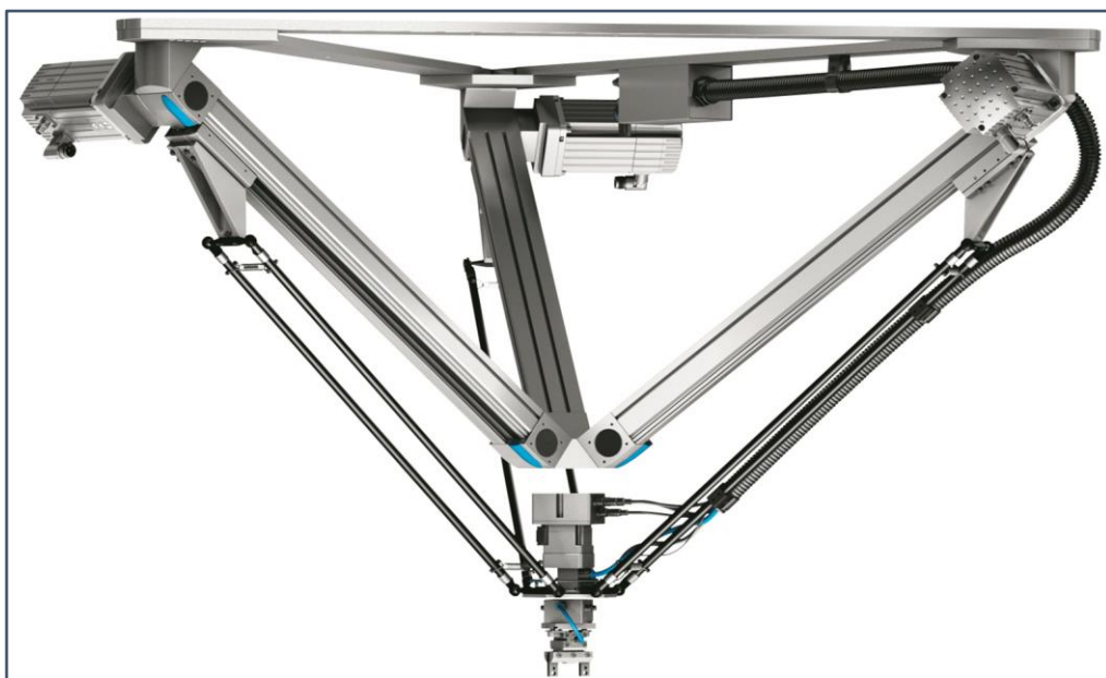
Εικόνα 2.17: Παράλληλος μηχανισμός από την FESTO με τρία πόδια, τριών βαθμών ελευθερίας με γραμμικούς επενεργητές.
