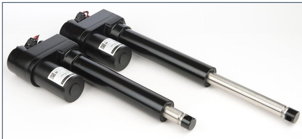
Εικόνα 2.3: Γραμμικοί επενεργητές από την Industrial Devices (GB), τάση 12 ή 24 Volt, μέγιστο φορτίο 2500Nt, διαδρομή 600mm.
