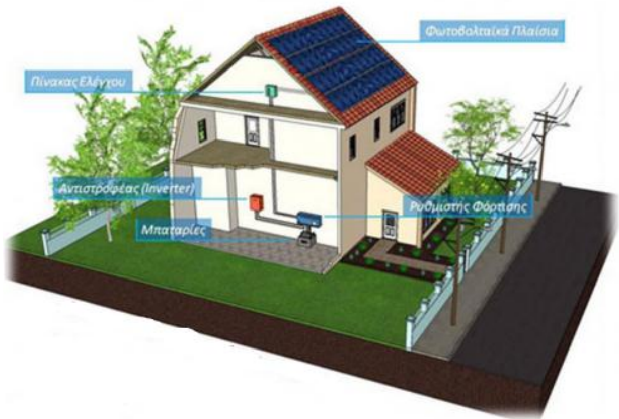
Εικόνα 3.2 Αυτόνομο Φωτοβολταϊκό Σύστημα
